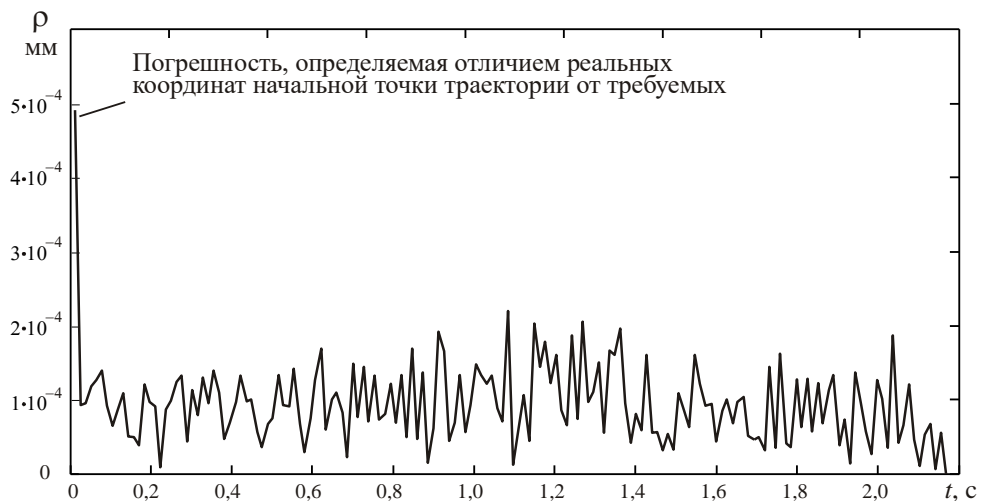
Рисунок 193 – Погрешность формирования траектории (по линейным координатам) при использовании анализа значений погрешности \rho для элементов массива возможных положений рабочего органа в конце каждого периода несущей
