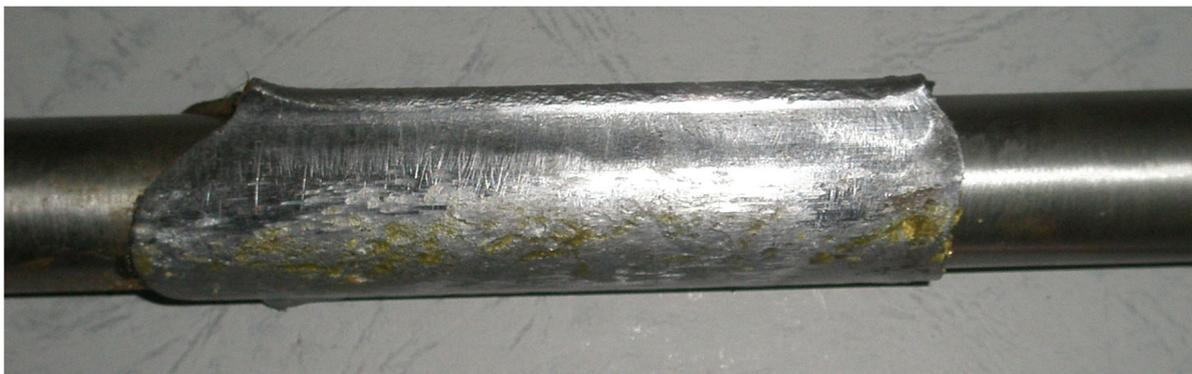
Рис. 3.7. Фотография патрубка (с раздутыми концами) с оправкой после первого прохода (на теле раската канифоль)
