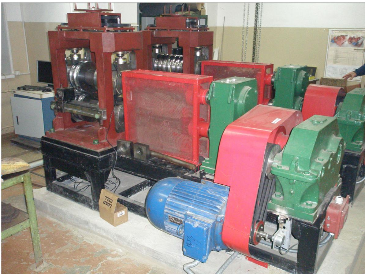
Рис. 3.2. Общий вид экспериментальной установки с двухвалковыми клетями 260
