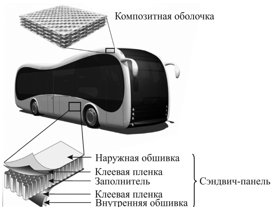
Рисунок 6 – Бескаркасный кузов автобуса [23]
