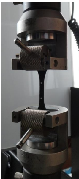
Рисунок 45 – Вид образца с метками для испытаний на растяжение
