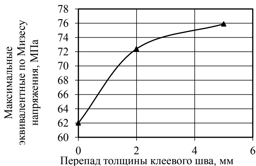
Рисунок 24 – Максимальные эквивалентные по Мизесу напряжения в основных несущих трубах каркаса в зависимости от разницы толщины клеевого шва между соседними панелями
