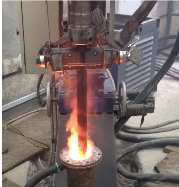
Рисунок 3.6 – Проведение опыта по получению полых слитков методом ЭШП по одноэлектродной схеме
