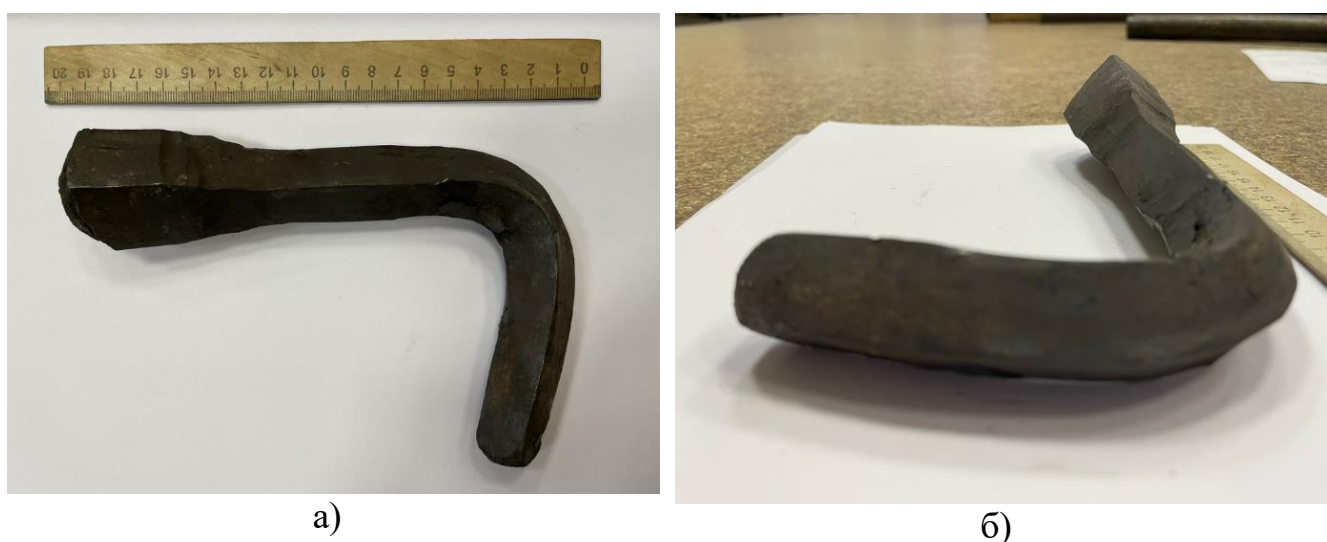
Рисунок 5.1 – Внешний вид проб на пластичность после деформации: а – плавка UNS S32750-1; б – UNS S32750-2
