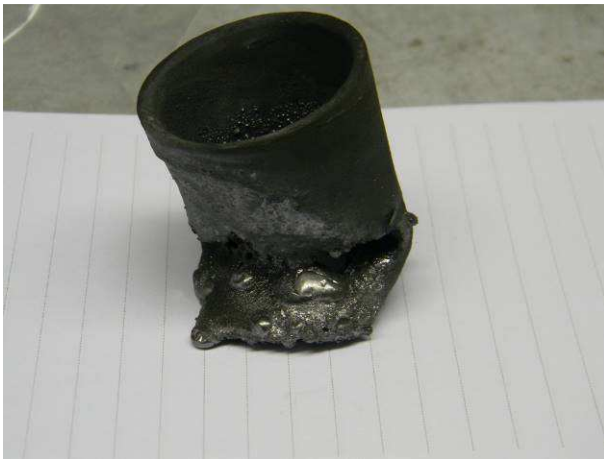
Рис. 43. Расплавление алундового тигля в печи Таммана при нагреве до 1700°С при разделении плавлением
