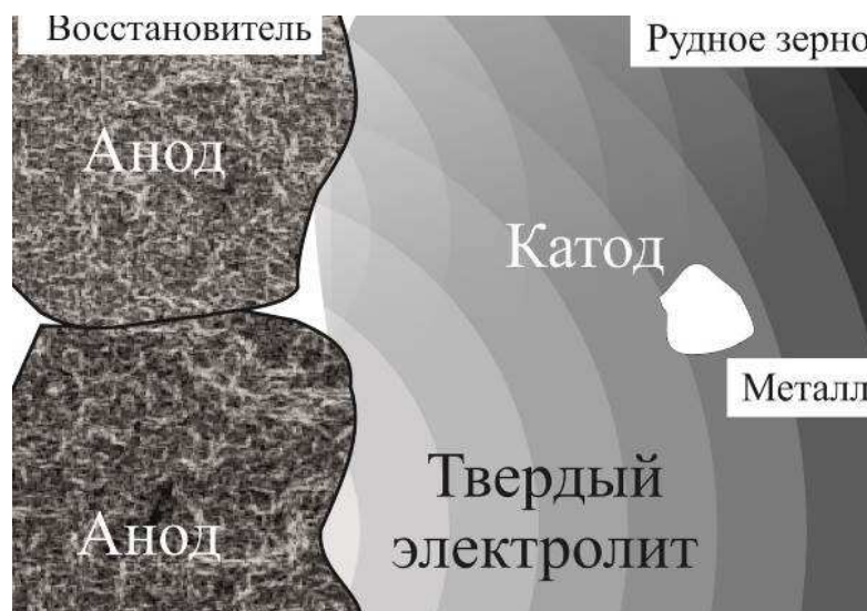
Рис. 50. Схема концентрационного гальванического элемента, образующегося в восстановительных условиях
