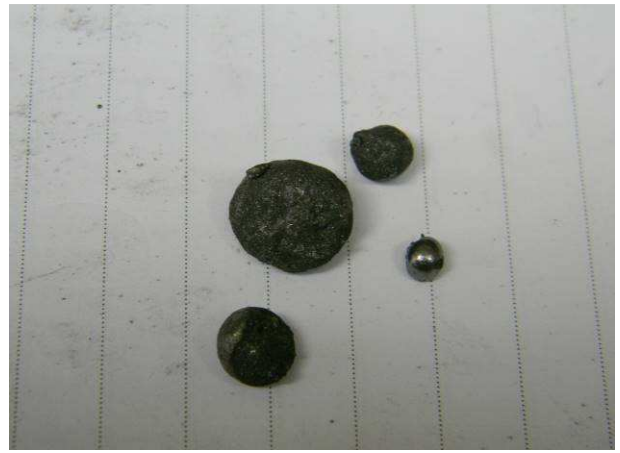
Рис. 44. Капли металла, полученные при давлении колпачка термопары на металлизированный порошок
