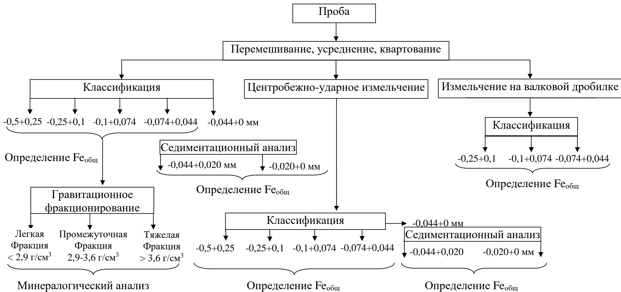
Рис. 29. Схема разделки пробы
