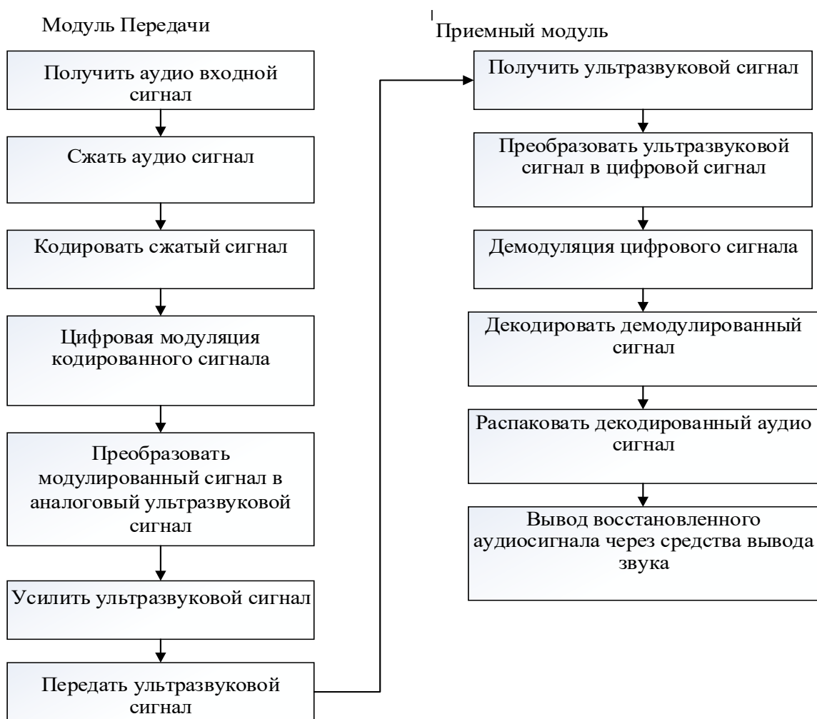
Рис.1.10. Блок-схема, описывающая состав и прямо-передающие процессы ультразвуковой связи
