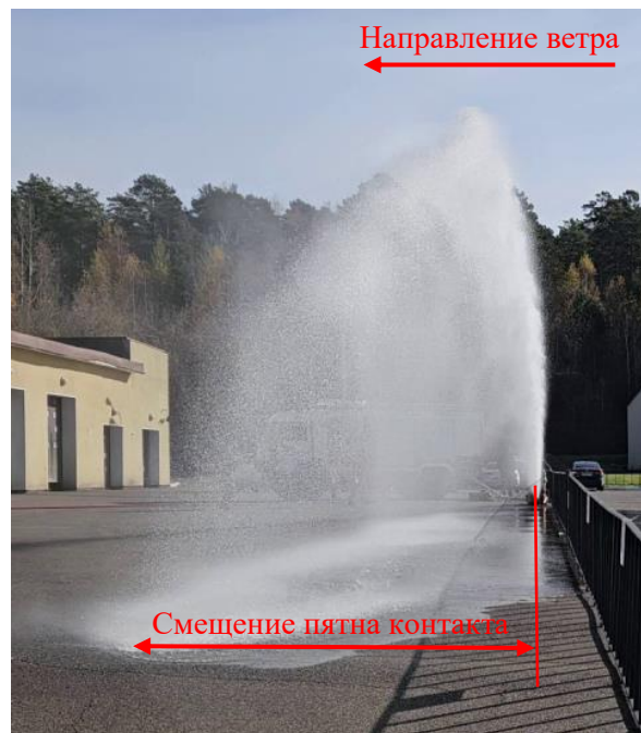
Рисунок 1.1 – Смещение пятна контакта струи воды из пожарного лафетного ствола под воздействием бокового ветра
