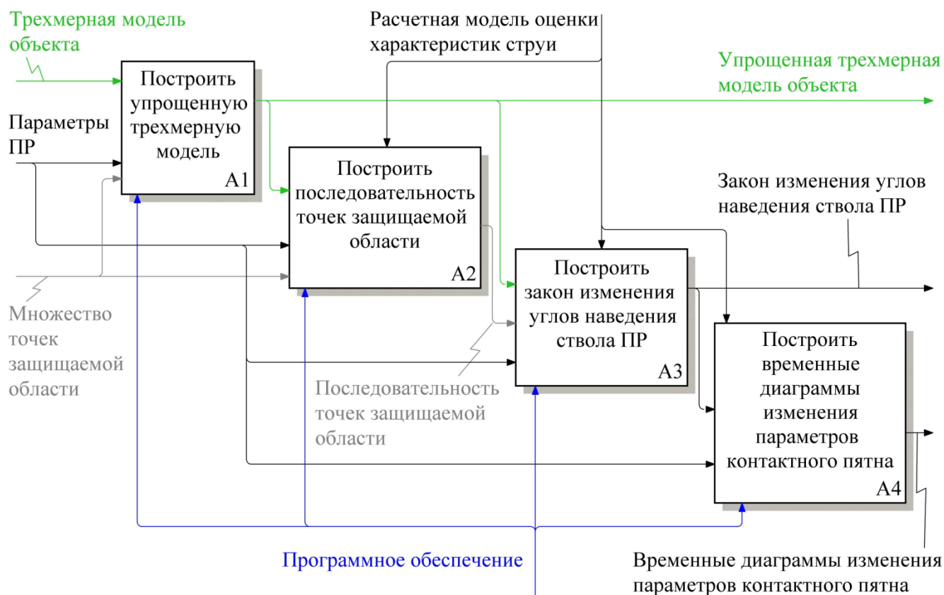
Рисунок 6.11 – Функциональная диаграмма IDEF0 метода синтеза закона изменения углов наведения пожарного робота
