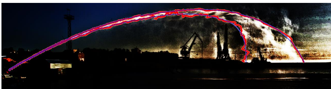
Рисунок 2.9 – Совмещенное изображение струи и ее границ, построенных на основе распознавания
