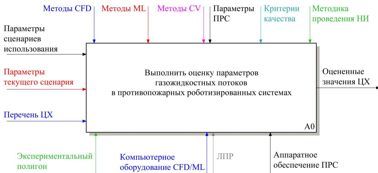
Рисунок 1.12 – Функциональная диаграмма IDEF0 методологии оценки характеристик газожидкостного потока в режиме реального времени
