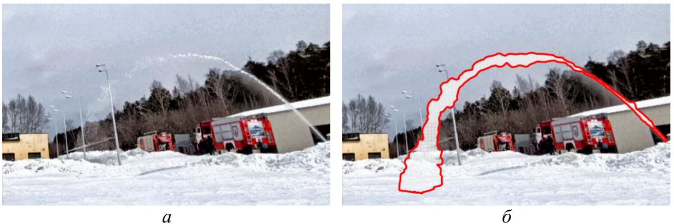
Рисунок 4.5 – Фрагменты изображения струи огнетушащего вещества из пожарного лафетного ствола исходного ( a ) и после выделения границ ( б )
