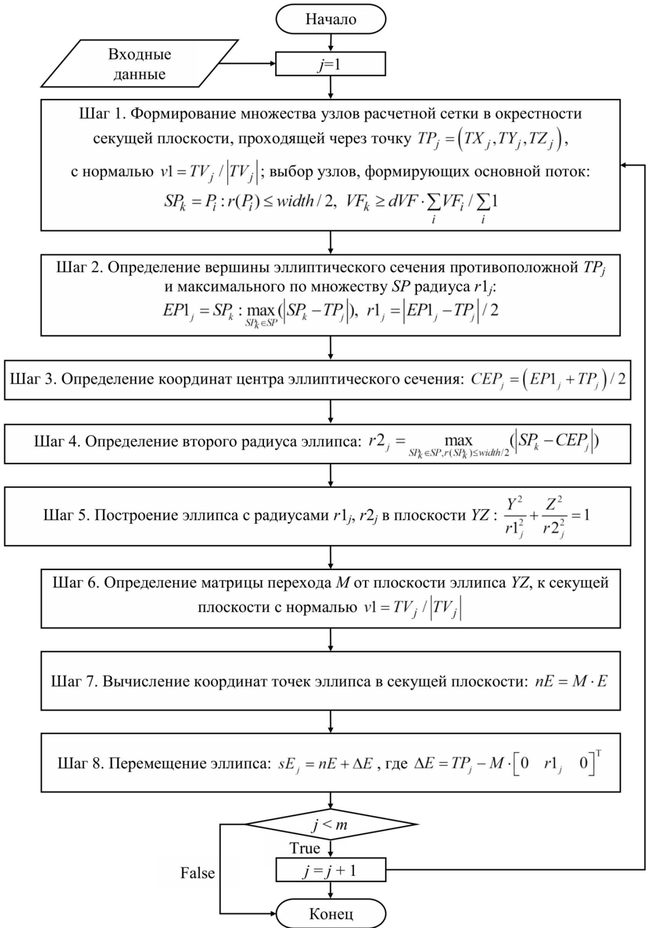
Рисунок А.4 – Блок-схема алгоритма аппроксимации потока эллиптическими сечениями
