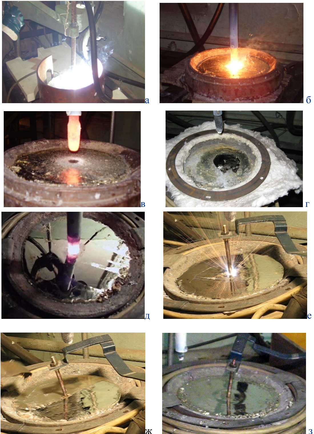
Рисунок 3.6 – Этапы проведения эксперимента: а – включение экспериментальной установки; б – зажигание дуги; в – отключение дуги; г – проплавление колодца; д – свободная поверхность расплава; е – подключение медного стержня; ж – удаление шлака скребком; з – погружение медного стержня в расплав
