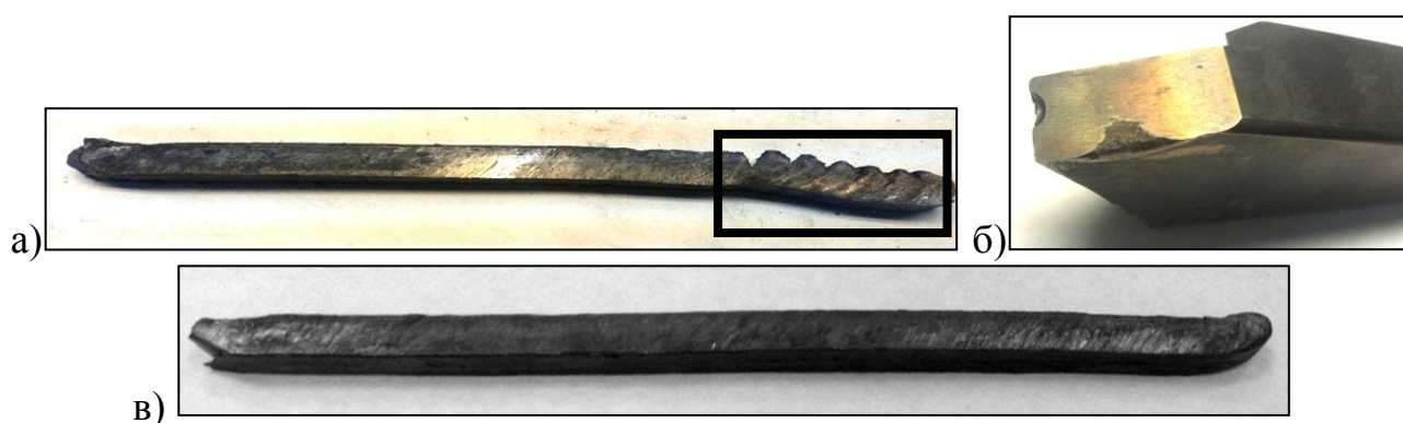
Рисунок 4.1 – Внешний вид заготовки сплава Ti-6Al-7Nb, подвергнутой 2 циклам РКУП-К при 500 °С (а). Рабочая поверхность упора после деформации при 500 °С (б). Внешний вид заготовки, полученной после 6 циклов РКУП-К при 550 °С.
