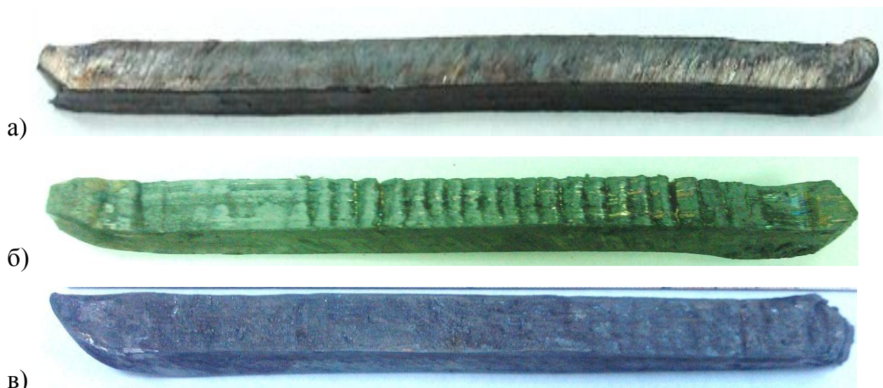
Рисунок 4.5 – Типичный вид заготовки сплава Ti-6Al-7Nb, полученной РКУП-К при T = 550\text{ }^{\circ}\text{C} и \dot{\epsilon} \sim 3\text{c}^{-1} : а) \square 11,2 \times 11,2\text{ мм}^2 , 6 проходов; б) \square 13,5 \times 13,5\text{ мм}^2 , 3 прохода; в) \square 13,5 \times 13,5\text{ мм}^2 , 6 проходов
