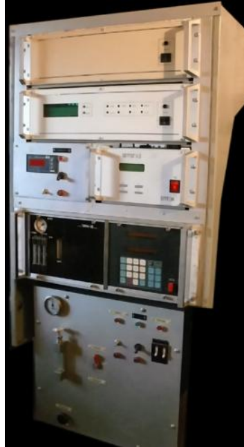
Рисунок 3.10 – Газоаналитическая система Тест-1С
