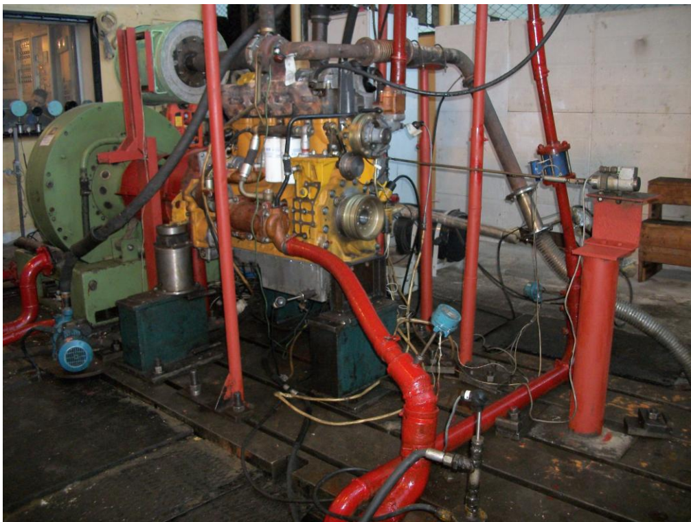
Рисунок 3.3 – Установка дизеля 4ЧН13/15 на стенде
