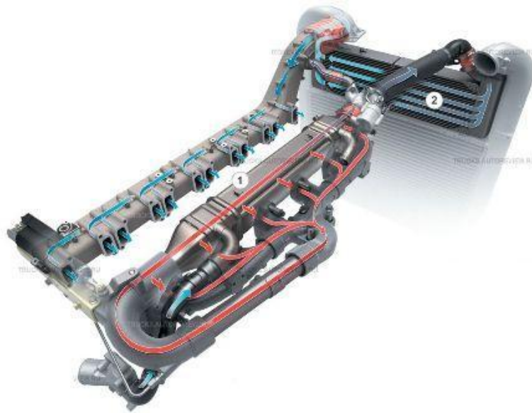
Рисунок 1.9 – Двухступенчатое охлаждение рециркулируемых газов в системе рециркуляции отработавших газов дизеля «Scania»:
