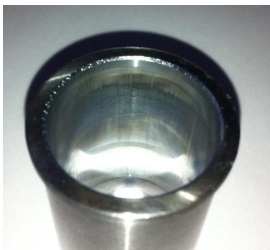
Рисунок 3.10 – Штатная гильза цилиндра после испытаний
