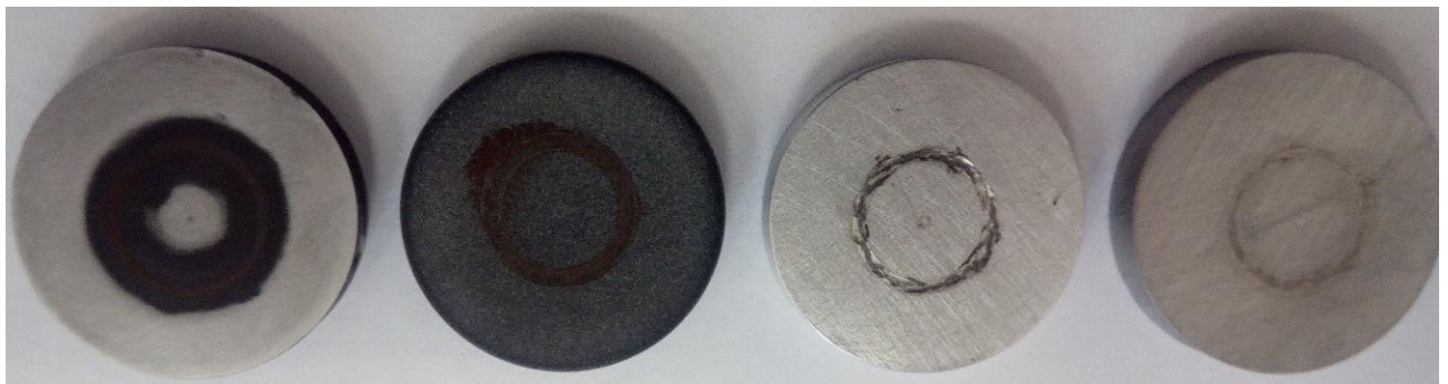
Рисунок 2.7 - Лабораторные образцы после испытаний на коэффициент трения, где слева направо: с ИУ-покрытием, с МДО-покрытием, без покрытия, из стали 40Х.
