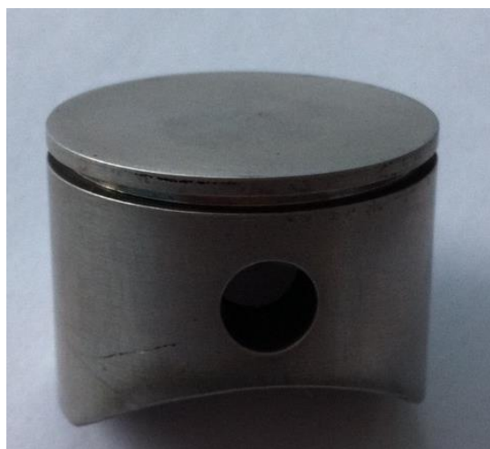
Рисунок 3.11 – Штатный поршень после испытаний
