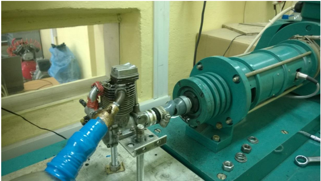
Рисунок 3.8 - Двигатель на стенде СТМ-3000
