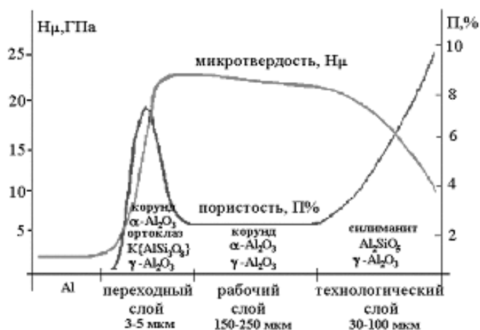
Рисунок 1.19 - Фазовый состав и некоторые свойства МДО-слоя на алюминии [35]
