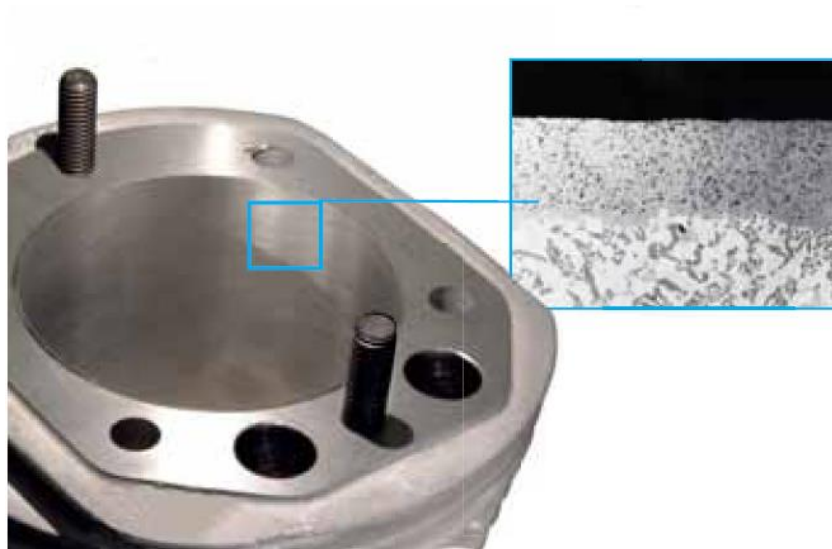
Рисунок 1.13 - Гильза цилиндра с покрытием Nikasil [21]
