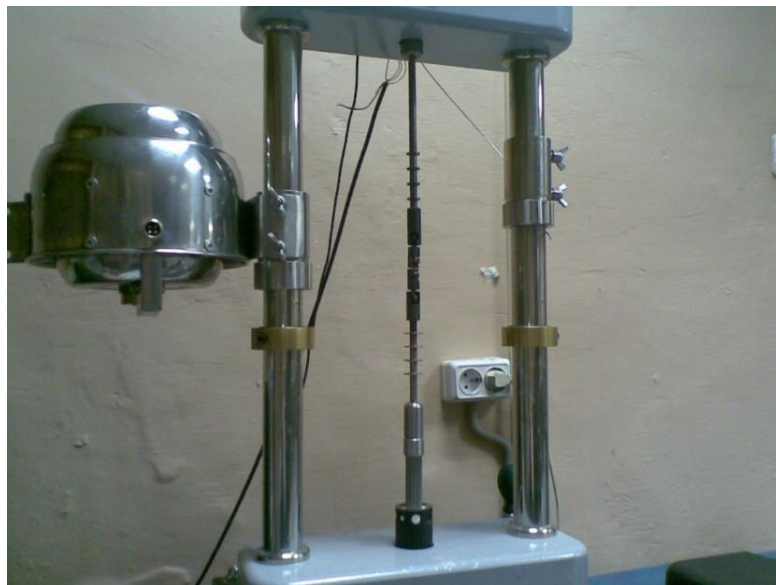
Рисунок 2.11 – Машина для растяжения малых образцов.
