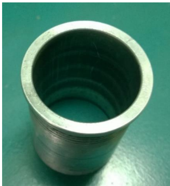
Рисунок 3.13 - Гильза цилиндра из сплава алюминия АК4-1 после ИУ
