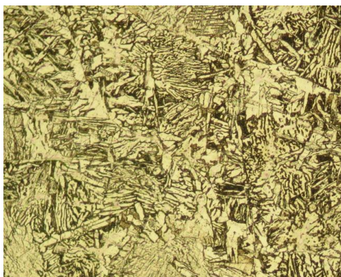
Рисунок 5.20 – Дендритная структура, x500
