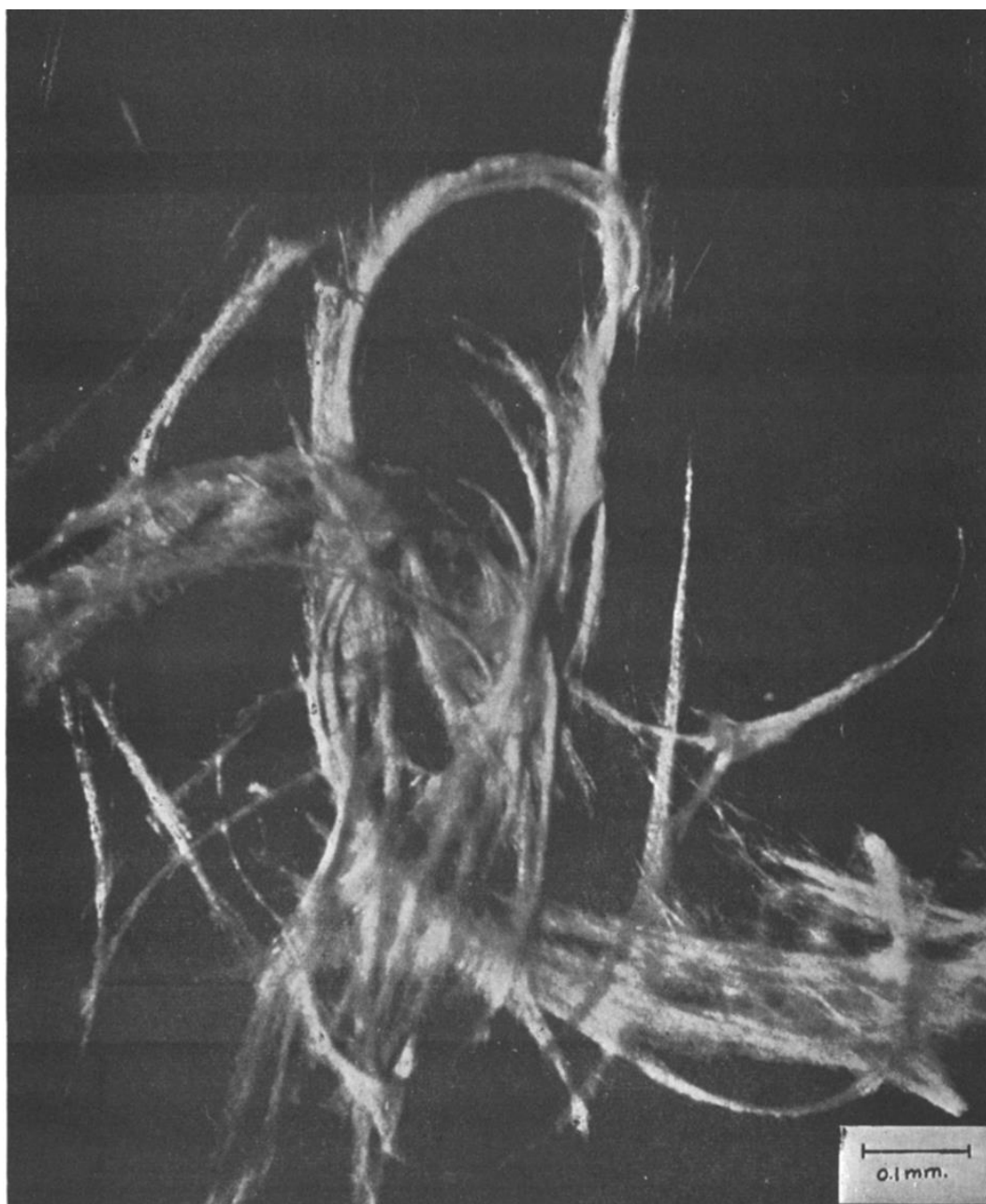
Рисунок 3— Фотография волокон гексатитаната калия, полученных гидротермальным методом синтеза, описанном в [31].
