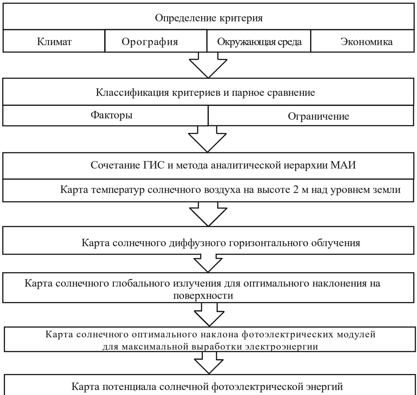
Рисунок 2.3 – Структура многокритериального подхода к принятию решений о строительстве солнечных электростанций
