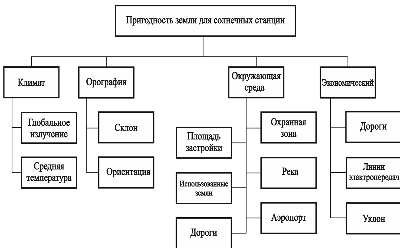
Рисунок 2.2 – Критерии и альтернативы принятия решения для выбора оптимальной площади строительства солнечной электростанции
