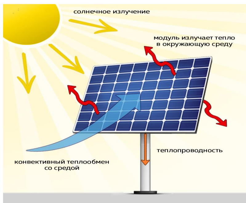
Рисунок 3.1 – Теплообмен в солнечном модуле [189]
