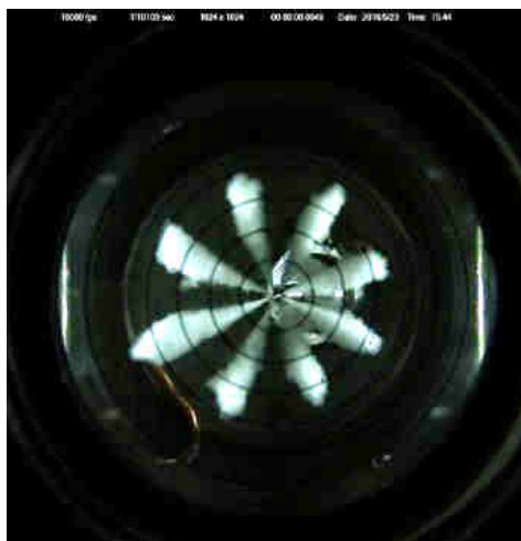
Рисунок 3.5 – Пример фотографии топливных факелов для распылителя с 8 распыливающими отверстиями диаметром 0,30 мм
