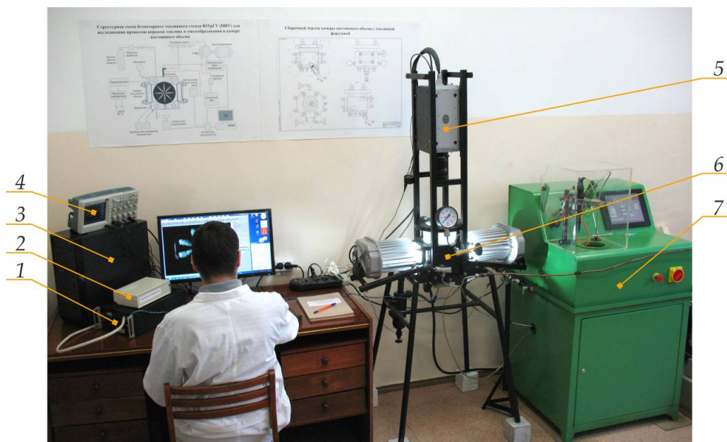
Рисунок 3.1 – Общий вид безмоторной экспериментальной установки для моделирования и исследования процесса смесеобразования: 1 – электронный блок управления; 2 – контроллер-синхронизатор; 3 – персональный компьютер; 4 – осциллограф; 5 – скоростная видеокамера; 6 – камера постоянного объёма со светодиодными светильниками; 7 – стенд для испытаний топливной аппаратуры аккумуляторного типа
