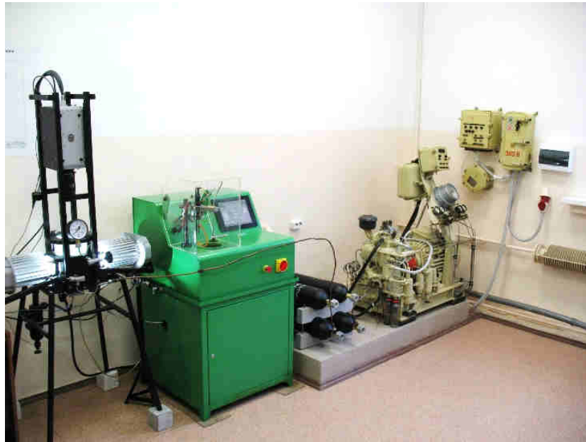
Рисунок 3.2 – Общий вид безмоторной экспериментальной установки для исследования процессов впрыска и распыливания топлива
