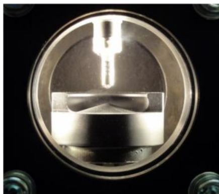
Рисунок 1.23 – Вид испытательной камеры с разрезом кроны поршня и инжектора, установленного внутри [124]
