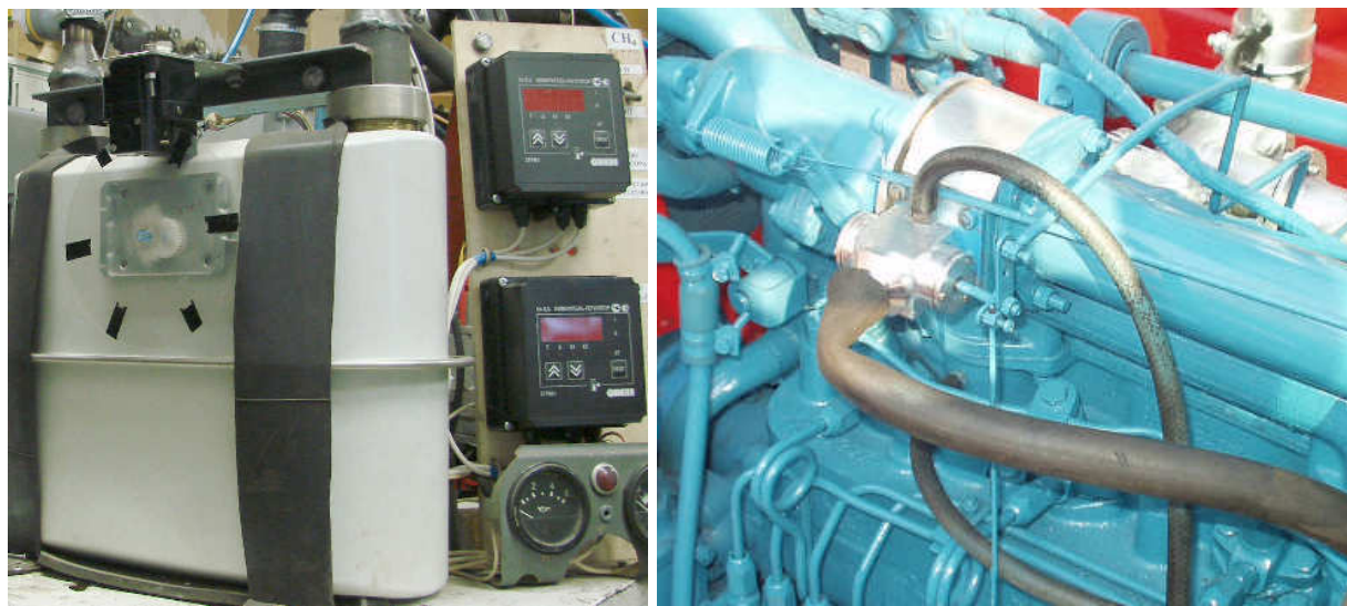
Рисунок 3.5 - Вид на счетчик расхода газа ВК-G16 (а) и смеситель-дозатор, установленный на двигателе (б)
