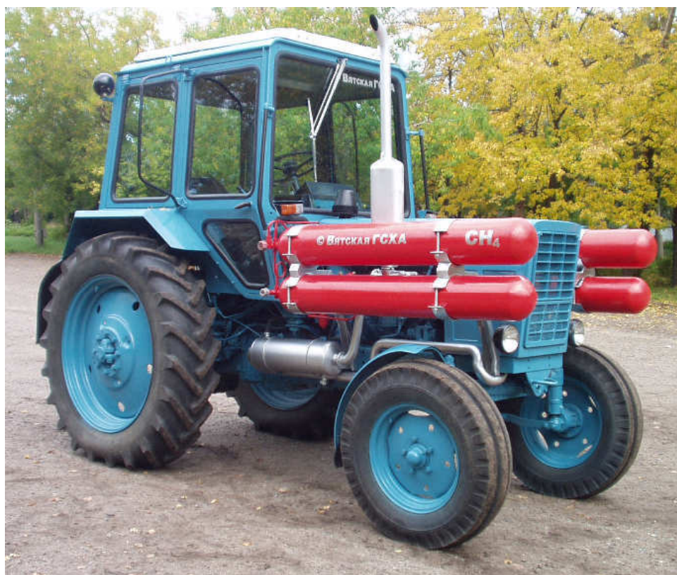
Рисунок – Макетный образец трактора МТЗ-80, модернизированный для работы на ПГ и СТЭ
