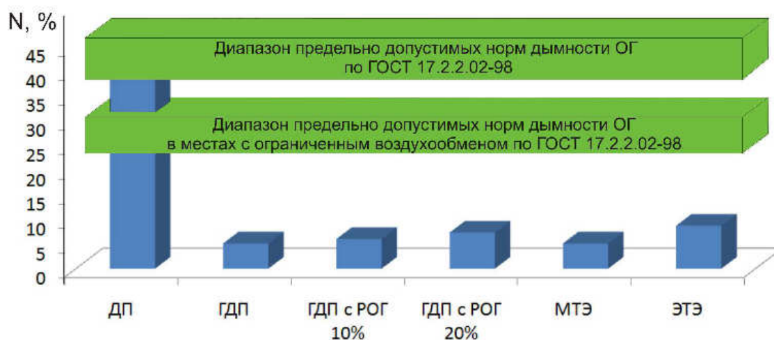
Рисунок 7.6 – Диаграмма дымности ОГ дизеля 4Ч 11,0/12,5 при работе на ПГ и СТЭ в соответствии с требованиями ГОСТ 17.2.2.02-98
