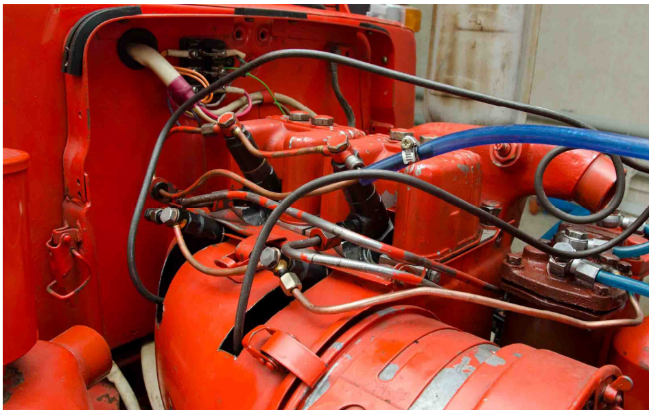
Рисунок Г-2 – Вид головок цилиндра с двойной системой топливоподдачи, установленных на тракторе
