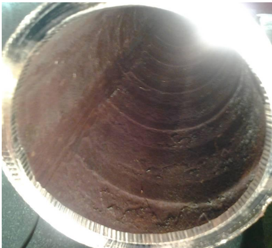
Рисунок 4.29 – Спираль на внутренней поверхности трубы
