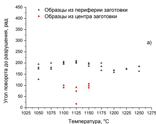
Рисунок 3.8 – Зависимость угла поворота до разрушения образцов из стали 20 от температуры нагрева, °C
