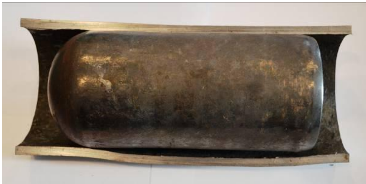
Рисунок 4.19 – Меридиональный разрез черновой трубы в очаге деформации обкатного стана, при ведении процесса по схеме «размер в размер»
