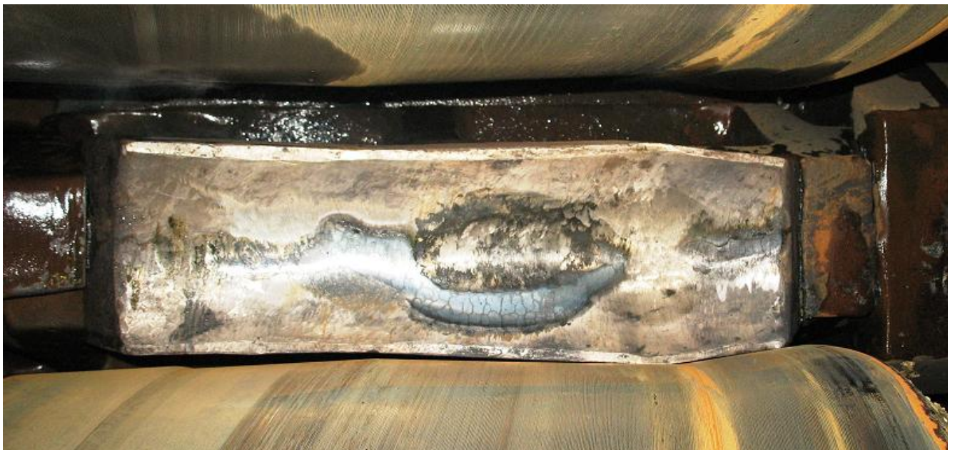
Рисунок 1.3 – Линейка в очаге деформации прошивного стана с кольцевым калибром на выходе, обеспечивающем уменьшение диаметра гильзы до 10%
