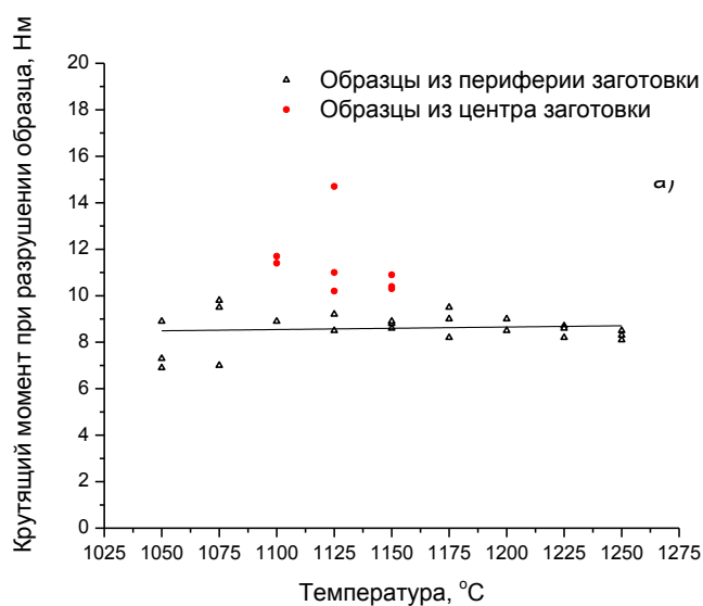
Рисунок 3.7 – Крутящий момент, при котором наблюдается разрушение образцов из стали 20
