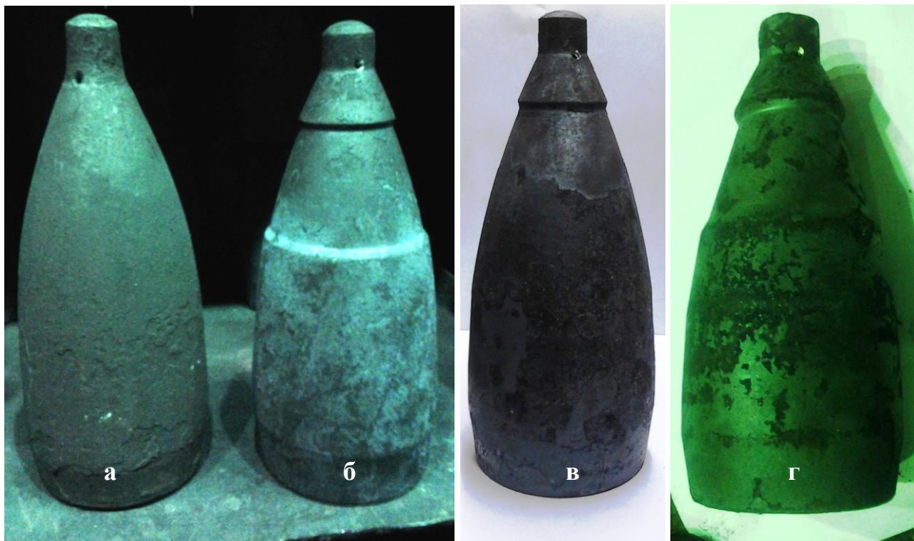
Рисунок 4.3 – Оправки прошивного стана: а – действующая (диаметр 110 мм);
