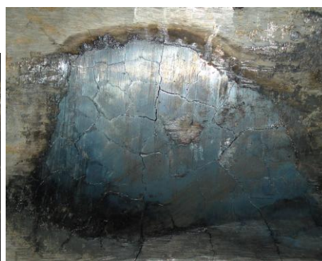
Рисунок 2.11 – Линейки прошивного стана после проведения 42 опытных прошивок с использованием ступенчатой калибровки валков:
