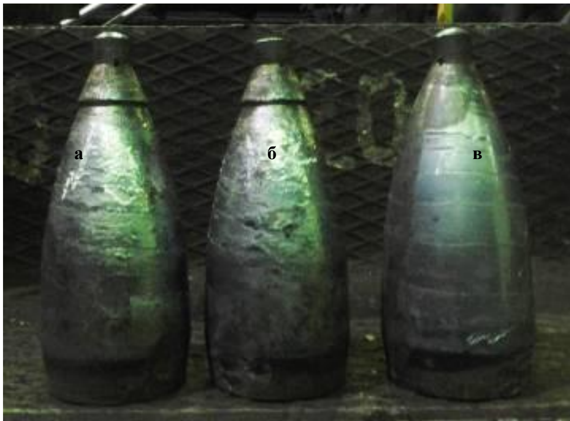
Рисунок 4.7 – Оправки прошивного стана: а – экспериментальная после прошивки 27 заготовок из стали 20; б – экспериментальная после прошивки 20 заготовок из стали 13ХФА; в – действующая после прошивки 2 заготовок из стали 20
