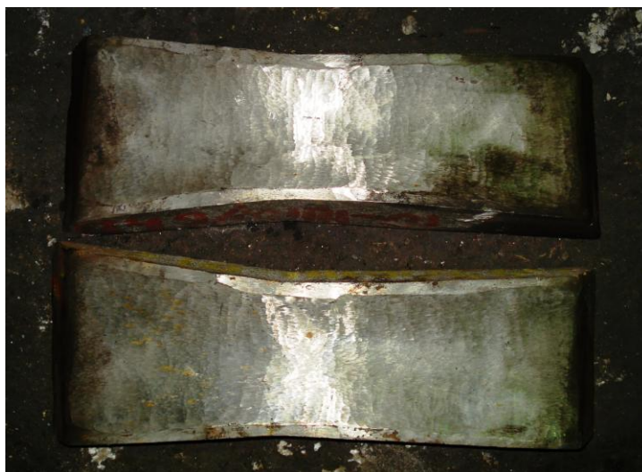
Рисунок 2.10 – Линейки прошивного стана до проведения опытных прошивок с использованием ступенчатой калибровки валков
