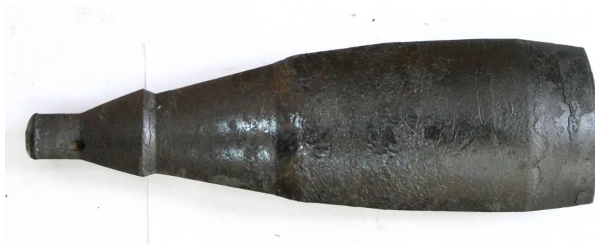
Рисунок 4.13 – Фрагмент оправки прошивного стана, извлеченной из заторможенной заготовки-гильзы
