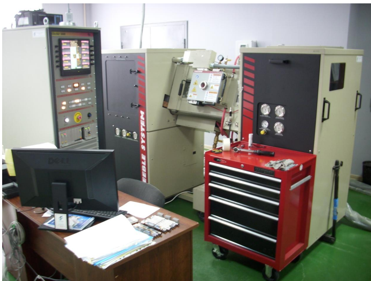
Рисунок 3.1 – Установка Gleeble с модулем горячего кручения
