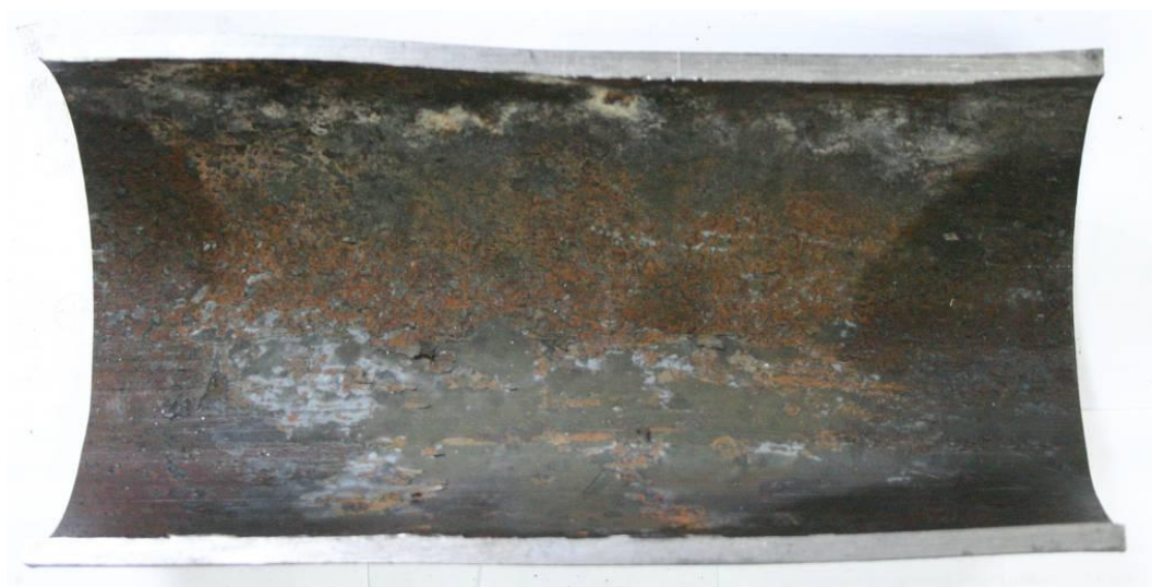
Рисунок 4.21 – Меридиональный разрез черновой трубы в очаге деформации обкатного стана, при ведении процесса обкатки с уменьшением диаметра
