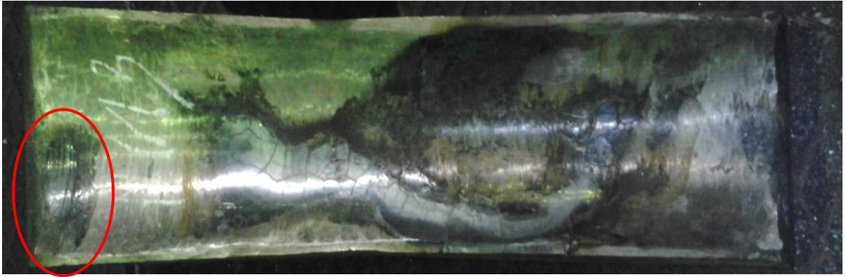
Рисунок 4.8 – Нижняя линейка прошивного стана после второй опытной прокатки
