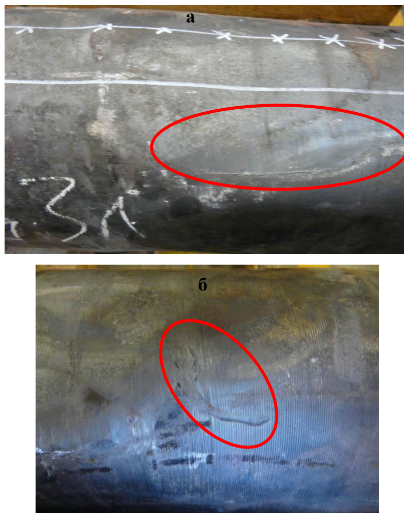
Рисунок 4.30 – К механизму образования пореза на наружной поверхности гильзы: а – задира поверхностного слоя гильзы острой кромкой линейки; б – грубый врез на поверхности гильзы от наваренной кромкой линейки
