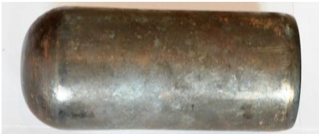
Рисунок 4.24 – Опытная оправка обкатного стана, после прокатки на ней 43 труб
