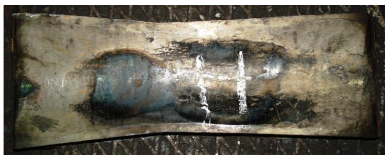
Рисунок 2.11 – Линейки прошивного стана после проведения 42 опытных прошивок с использованием ступенчатой калибровки валков:
