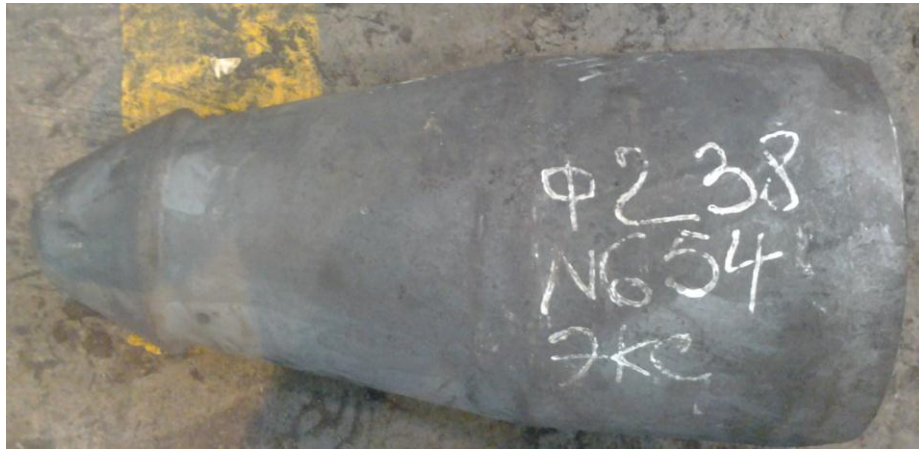
Рисунок 38 – Внешний вид экспериментальной оправки
