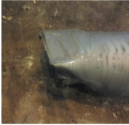
Рисунок 49 – Зажим заднего конца гильзы
