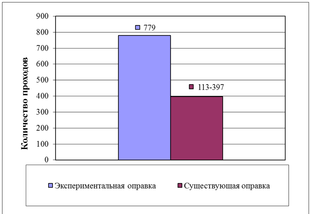
Рисунок 40 - Стойкость экспериментальной и существующих оправок диаметром 243 мм
