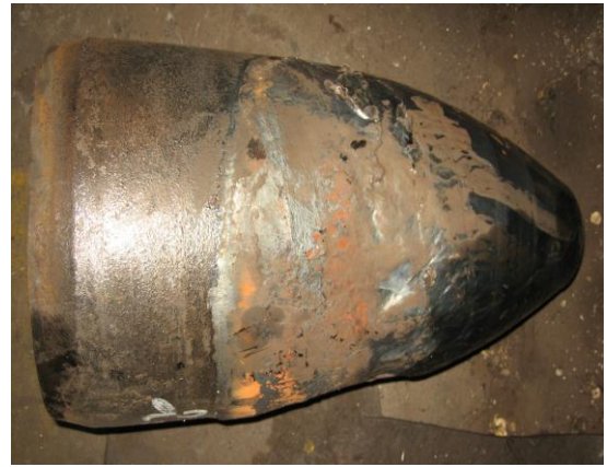
Рисунок 42 – Изношенная действующая оправка прошивного стана
