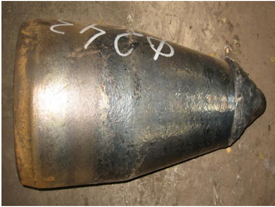
Рисунок 41 – Изношенная экспериментальная оправка прошивного стана
