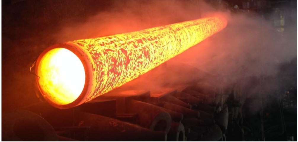
Рисунок 54 – Гильза диаметром 328 мм и толщиной стенки 23,7 мм
