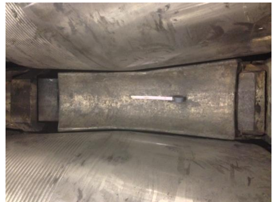
Рисунок 52 – Фрагмент очага деформации
