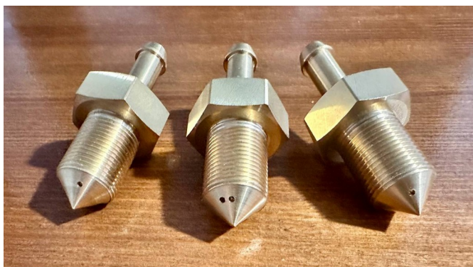
Рисунок 4.2 – Экспериментальные образцы распыливающих устройств
