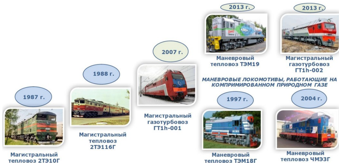
Рисунок 1.1 – Проекты конвертирования тепловозов для работы по газодизельному и газовому циклам [88]
