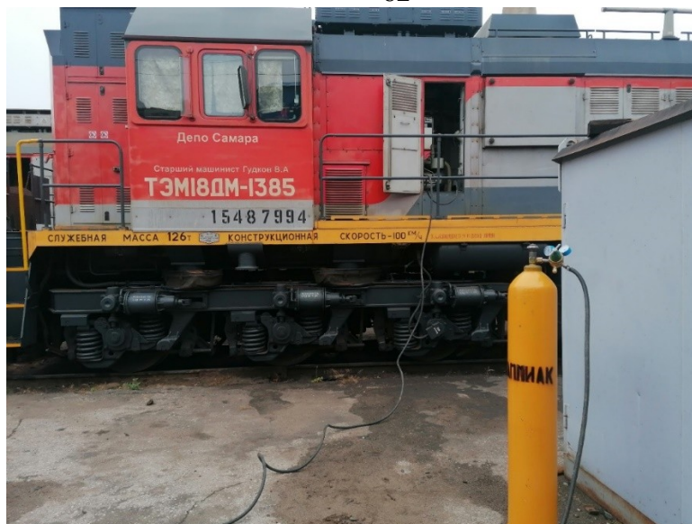
Рисунок 4.1 – Монтаж системы для подачи аммиака во впускной коллектор двигателя маневрового тепловоза
