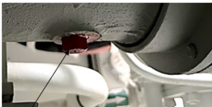
Заглушка, вместо которой монтировать распыливающее устройство
