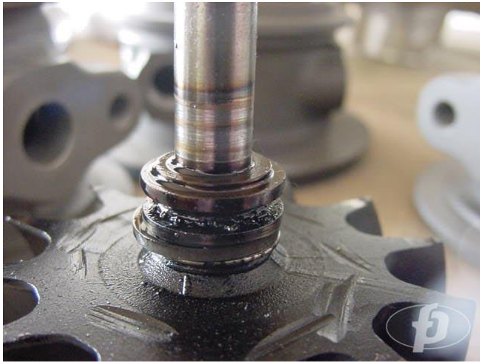
Рисунок 1.12 – Подгоревшие остатки масла в области уплотнительного кольца [22]
