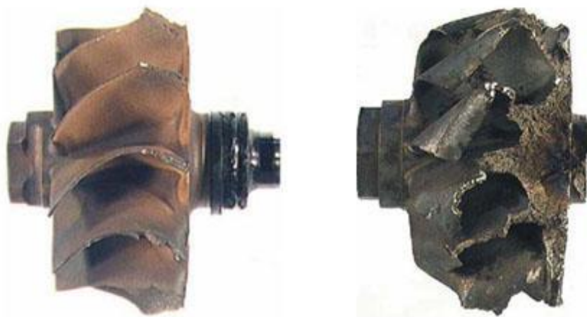
Рисунок 1.11 – Износ лопаток рабочих колес турбины и компрессора из-за превышения частоты вращения [22]
