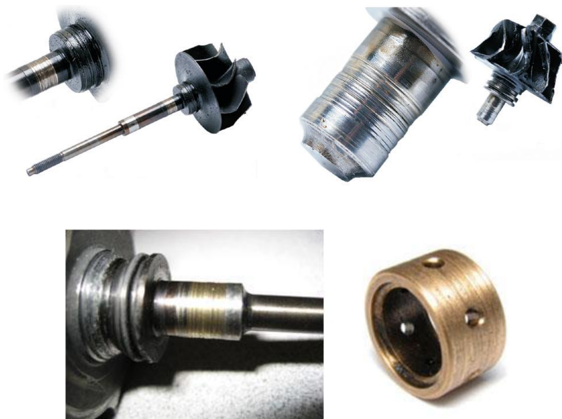
Рисунок 1.10 – Износ вала и подшипников из-за загрязненного масла [17,22]
