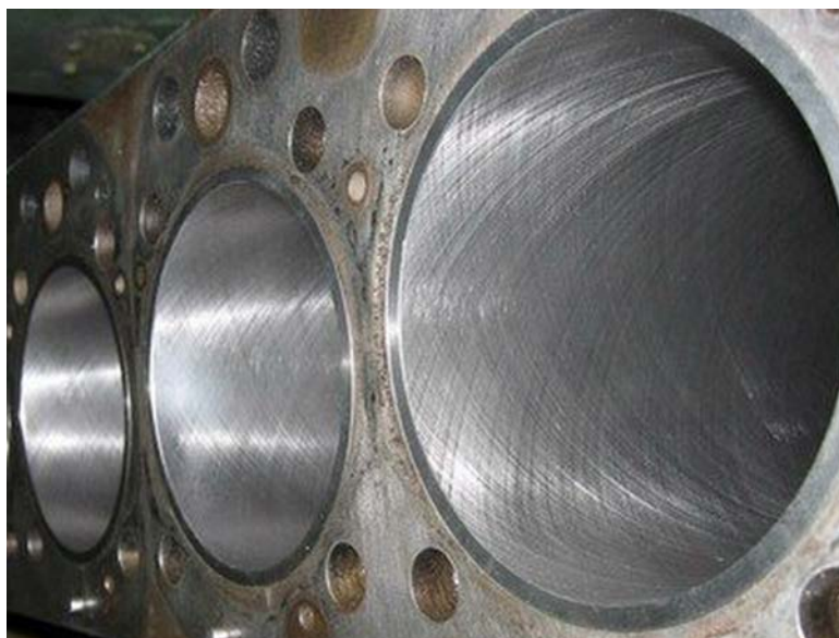
Рис 4.10. Поверхность цилиндров после хонингования
