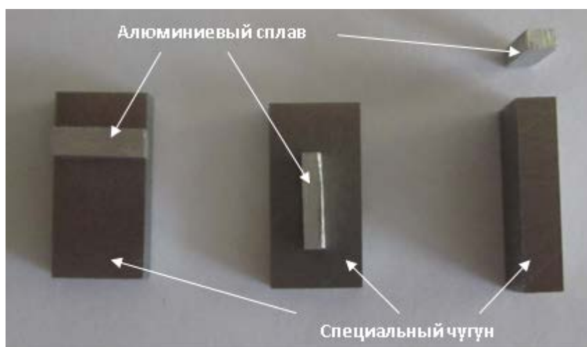
Рис. 5.2. Экспериментальные элементы трибосопряжения «поршень-цилиндр» дизеля ЧН 13/15
