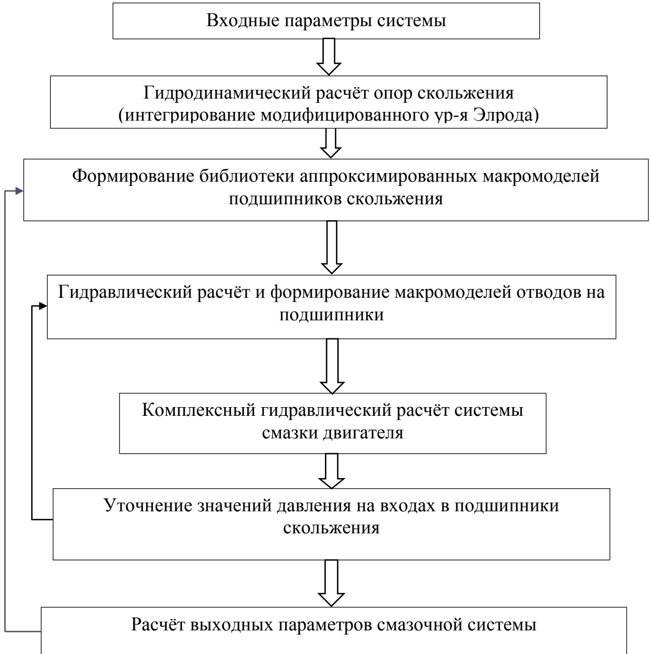
Рис. 3.2. Алгоритм расчета смазочной системы дизеля с общим источником маслообеспечения
