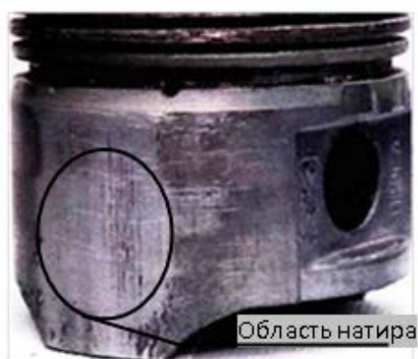
Рис.4.26. Результат контактного взаимодействия юбки поршня
