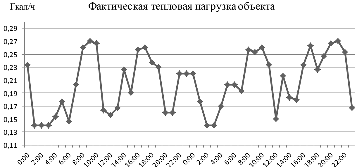
Рис. 4.20. Фактическая часовая тепловая нагрузка объекта
