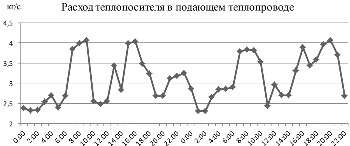
Рис. 4.19. Фактический часовой расход теплоносителя в подающем теплопроводе
