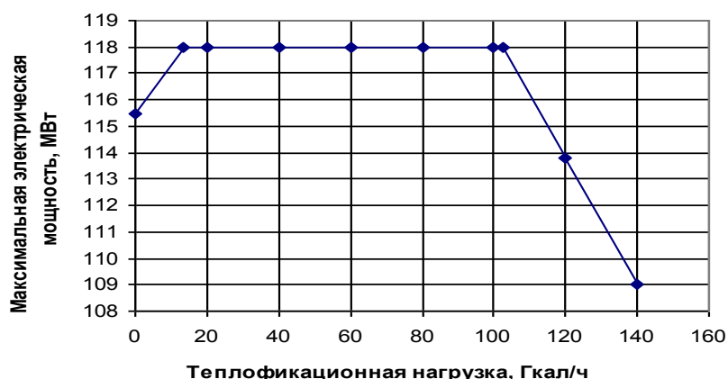
Рис. 1.5. Зависимость выработки электрической мощности от теплофикационной нагрузки на ЦЭС ОАО «ММК»
