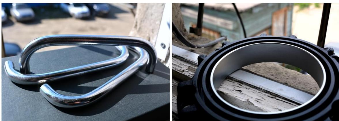
Рисунок 5.11 - Фотографии хромированных (твердый и молочный хром) изделий, покрытых на участке ООО "НПП Электрохимия" с использованием предложенной технологической схемы утилизации хрома (VI).
