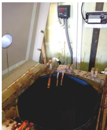
Рисунок 5.10.- Общий вид установки для очистки хромосодержащих стоков путем использования стальной стружки.
