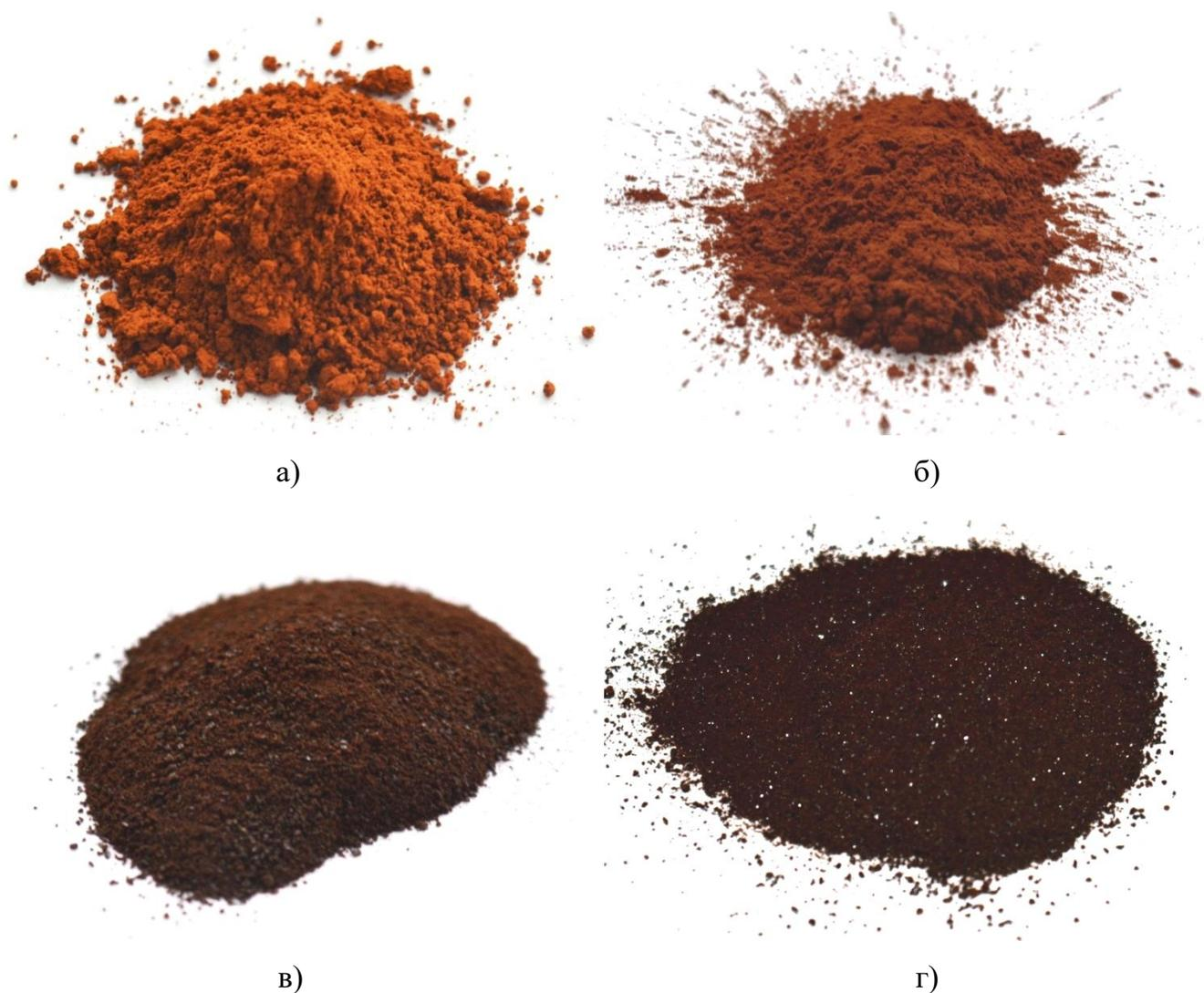
Рисунок 4.1 - Общий вид осадков в системе " $\text{CrO}_3 - \text{H}_2\text{SO}_4$  - стальная стружка" при исходном содержании  $\text{CrO}_3$ , г/л: а - 20, б - 100, в - 200, г - 400. Время выдержки на воздухе - 3 суток при температуре  $25^\circ\text{C}$
