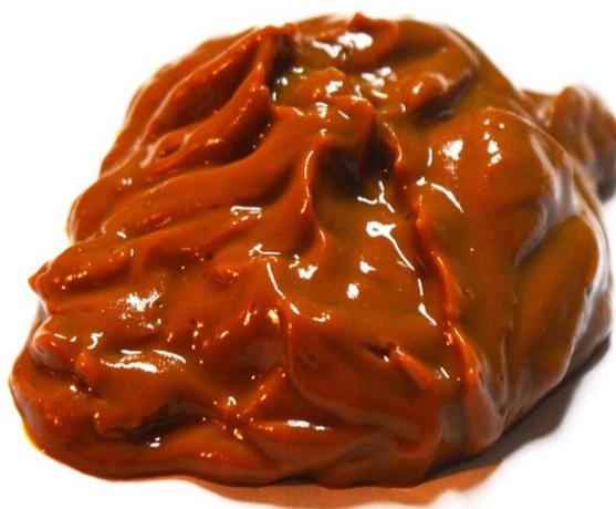
Рисунок 4.2 - Общий вид классического гальваношлама со станции реагентной очистки ОАО "Златоустовский часовой завод" без принудительной сушки. Время выдержки на воздухе - 3 суток при температуре  $25^\circ\text{C}$
