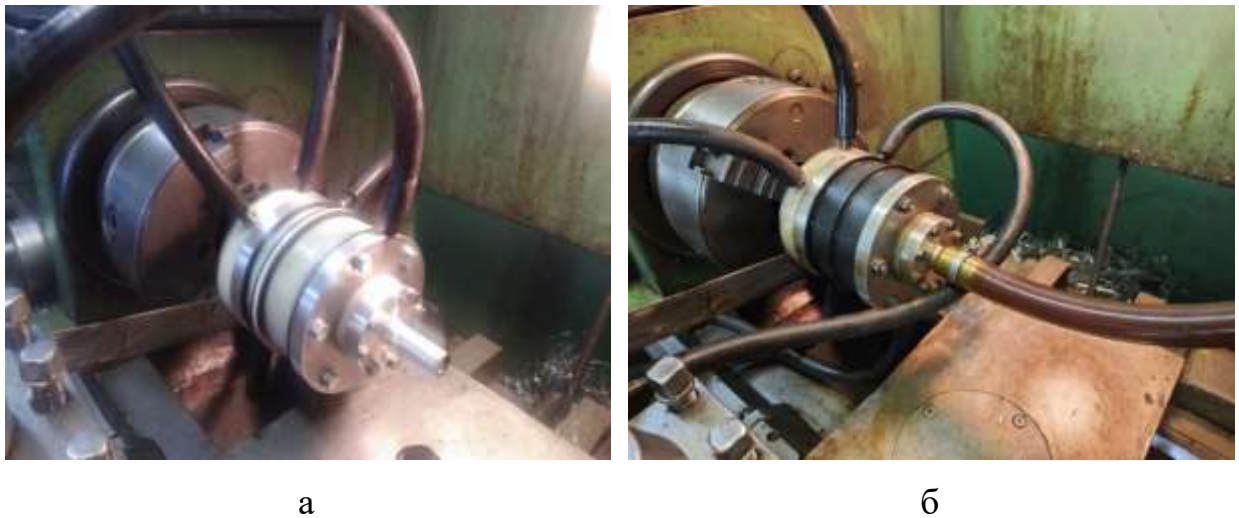
Рис. 5.9. Двухступенчатая ПРМ 3-2 с центральными зубчатыми колесами, выполненными из: а – пластик; б – сталь
