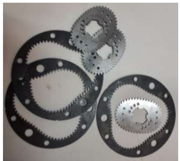
Рис. 5.8. Детали двухступенчатой ПРМ 3-2: а – пластик б – металл
