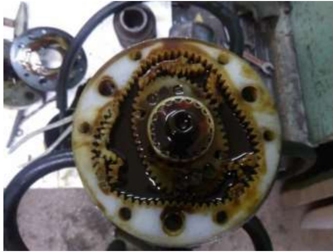
Рис. 5.7. Разрушение пластиковых деталей ПРМ вследствие перегрева
