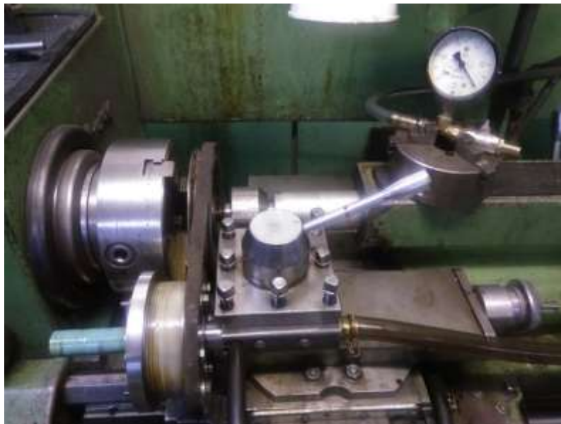
Рис. 5.5. Испытание одноступенчатой ПРМ 3-2 в режиме вакуумного насоса
