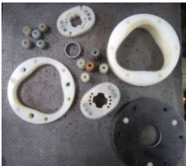
Рис. 5.8. Детали двухступенчатой ПРМ 3-2: а – пластик б – металл
