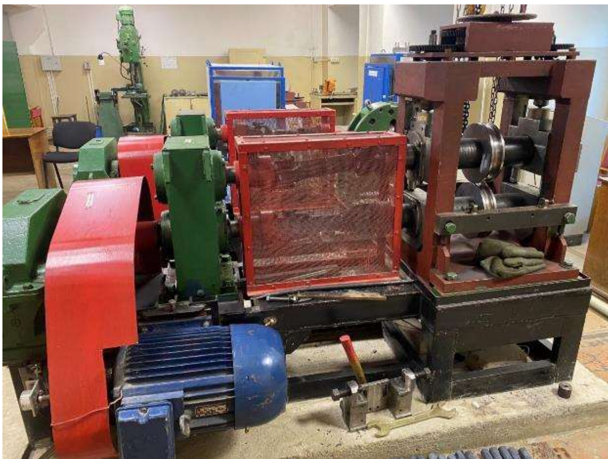
Рисунок 6.9 – Главная линия клетки с 2-валковым калибром
