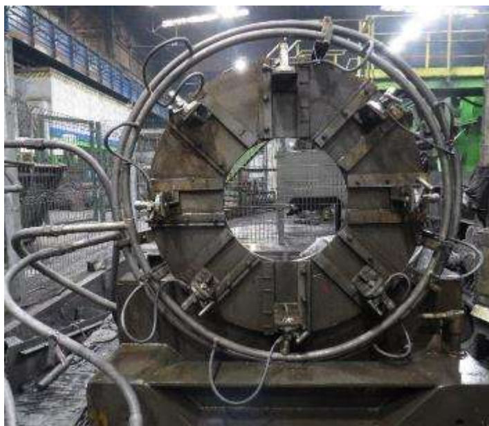
Рисунок 3.12 – Пример распылительного оборудования с клапанами и выпускными соплами для безвоздушного нанесения смазочной суспензии
