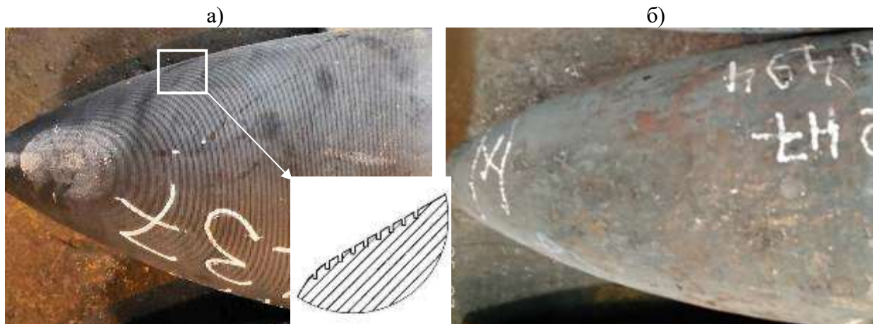
Рисунок 5.29 – Внешний вид рабочей поверхности новой оправки: а) с рифлением на рабочей поверхности; б) без рифления
