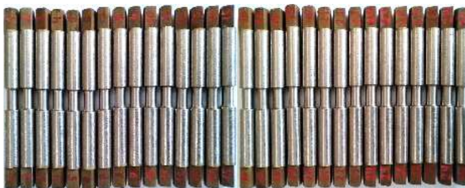
Рисунок 2.3 – Готовые образцы для пластометрических испытаний из НЛЗ из стали марки 08Х18Н10Т: а) на сжатие; б) на растяжение; в) на кручение
