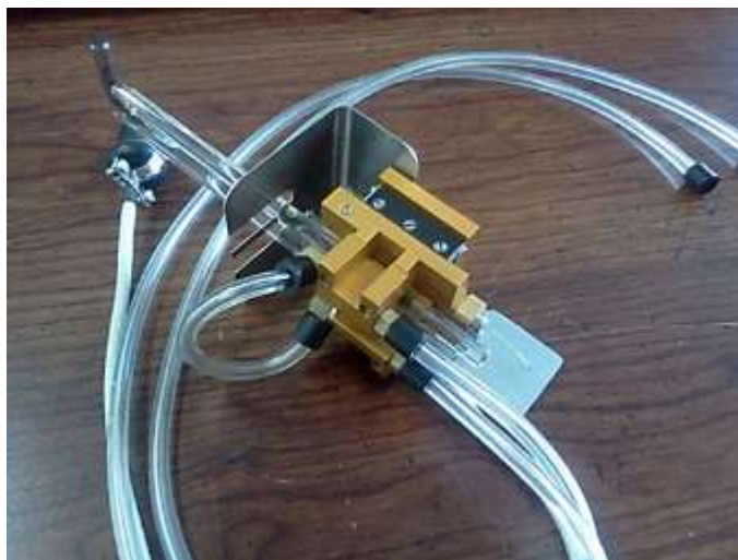
Рисунок 2.9 – Высокотемпературный датчик поперечной деформации (дилатометр)
