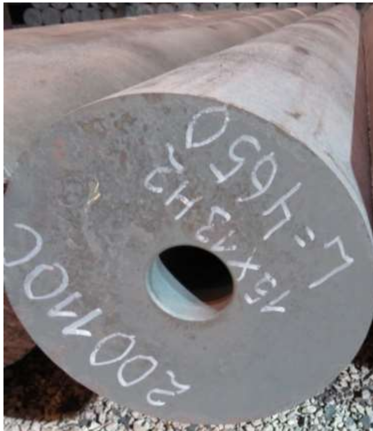
Рисунок 4.6 – вид полностью подготовленной к прокатке НЛЗ из стали марки 15X13H2 диаметром 340мм
