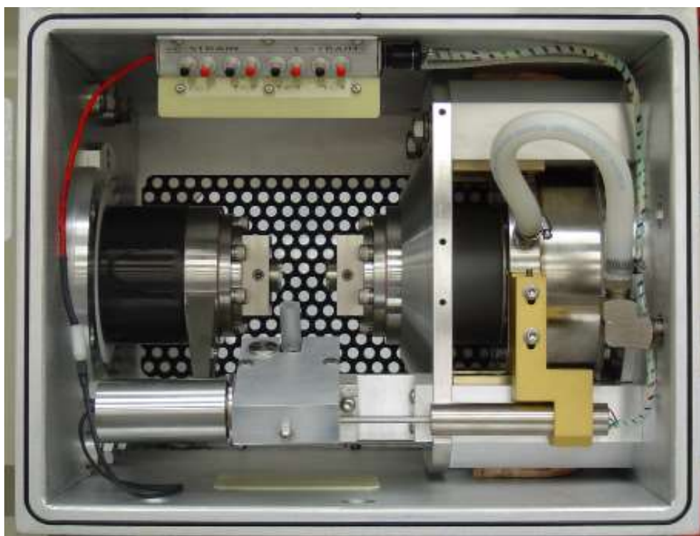
Рисунок 2.5 – Рабочая камера модуля HydraWedge
