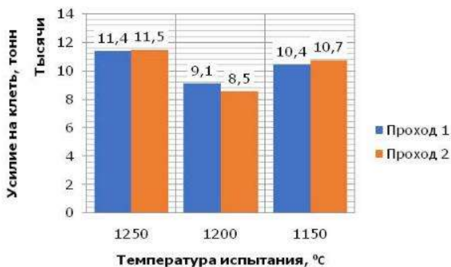
Рисунок 6.14 – Влияние температуры прокатки на величину усилия на клеть (диаметр оправки \varnothing 30,1 мм)
