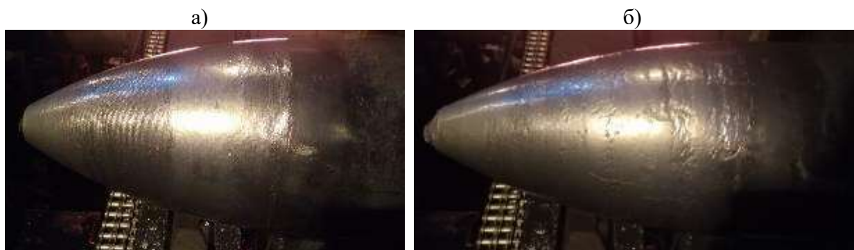
Рисунок 5.30 – Внешний вид прошивной оправки с рифлением при прошивке заготовок из стали типа 13Cr: а) после 3 проходов; б) после 60 проходов
