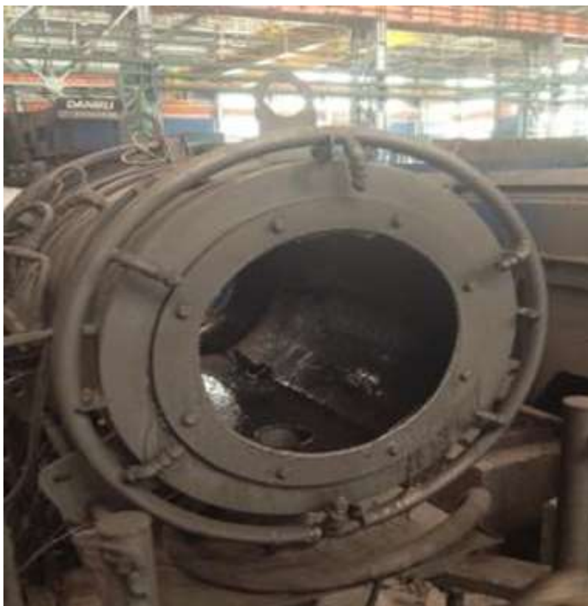
Рисунок 3.14 – Пример распылительного оборудования для нанесения смазочной суспензии АО «СТЗ»
