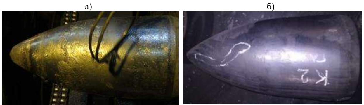
Рисунок 5.28 – Внешний вид прошивной оправки после трех проходов при прошивке заготовок из стали типа 13Cr: а) 20X2H4MФА; б) 20XH2MB3КБ
