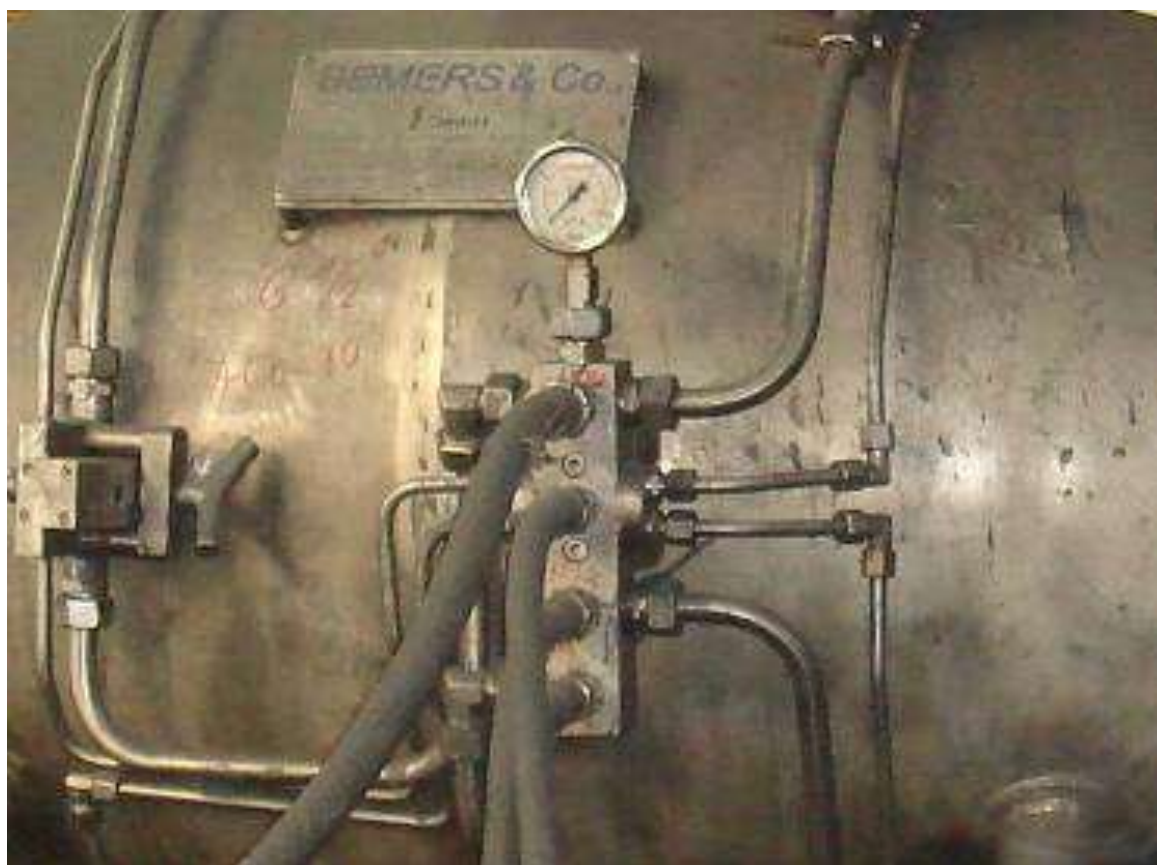
Рисунок 3.13 – Пример распылительного оборудования для нанесения смазочной суспензии
