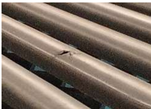
Рисунок 6.19 – Виды дефектов, вызванных превышением продольных усилий допустимых значений
