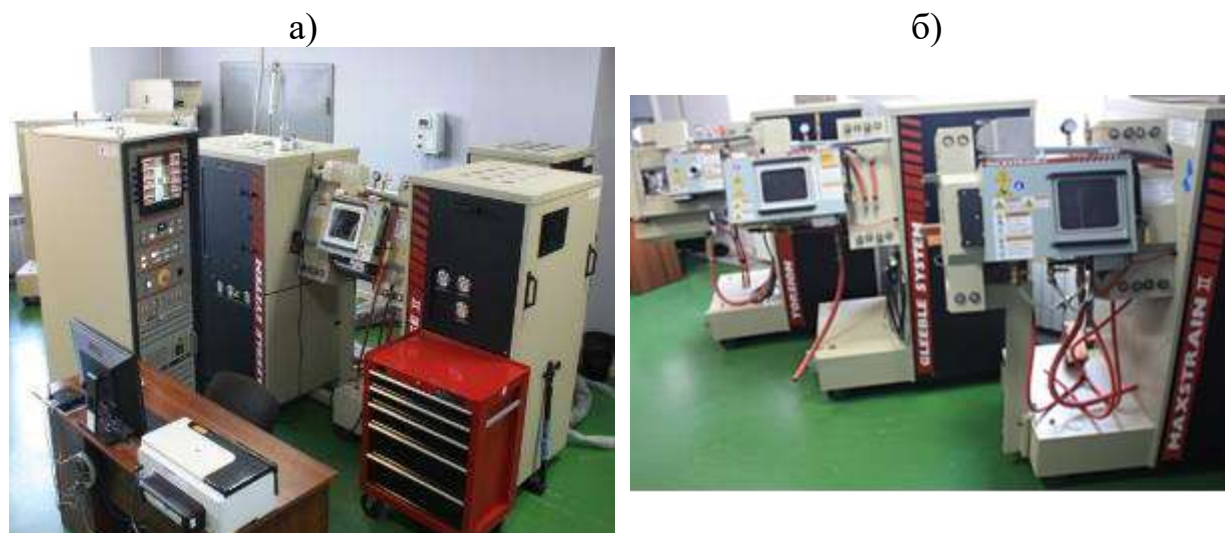
Рисунок 2.4 – Комплекс с цифровой замкнутой системой термомеханического моделирования «Gleeble 3800» ФГАОУ ВО «ЮУрГУ (НИУ)»: а) общий вид комплекса; б) подключаемые модули
