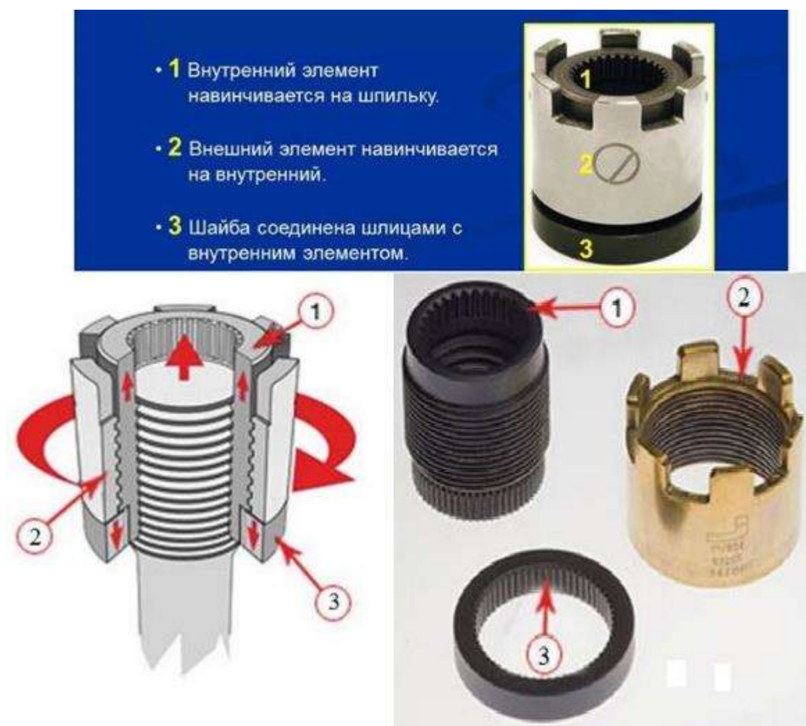
Рисунок 7.2 – гайка-механический натяжитель
