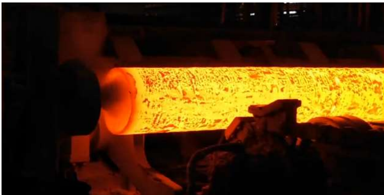
Рисунок 3.6 – Вдувание смазочно-дезоксирующего материала на внутреннюю поверхность гильзы
