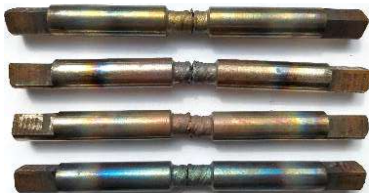
Рисунок 2.21 – Образцы после испытаний на кручение
