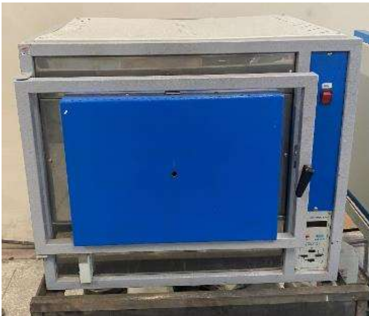
Рисунок 3.19 – Нагревательная печь ПКЛ-1,2-12
