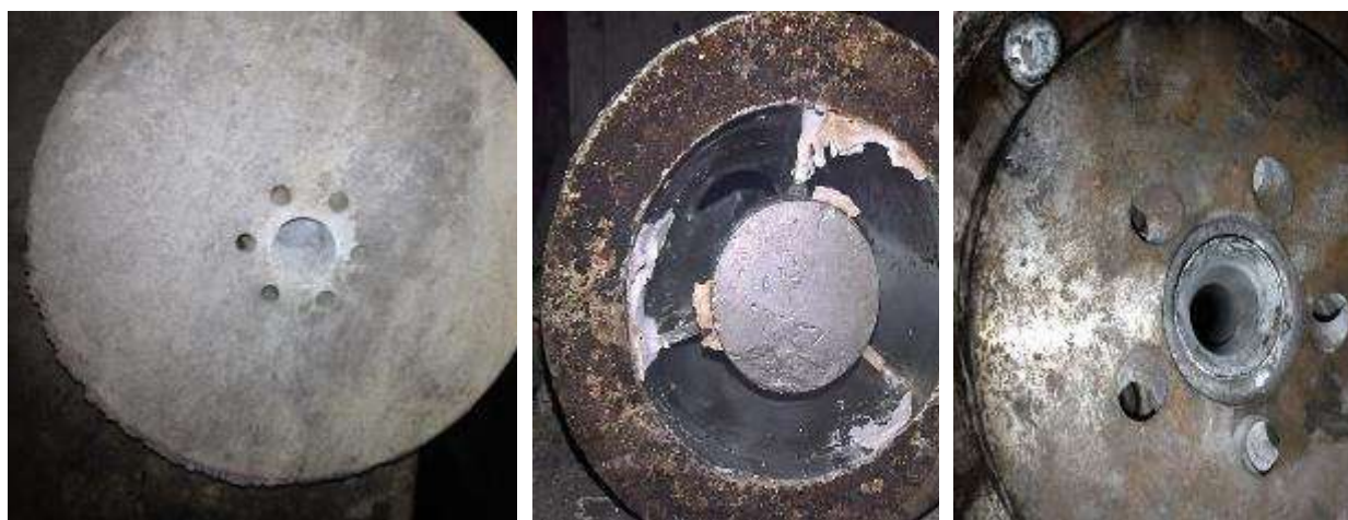
Рисунок 3.3 – Примеры оборудования для нанесения смазочно-дезоксирующего материала на внутреннюю поверхность нагретой гильзы
