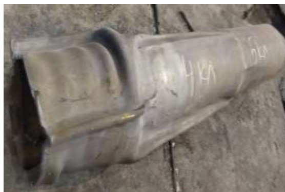
Рисунок 6.19 – Виды дефектов, вызванных превышением продольных усилий допустимых значений
