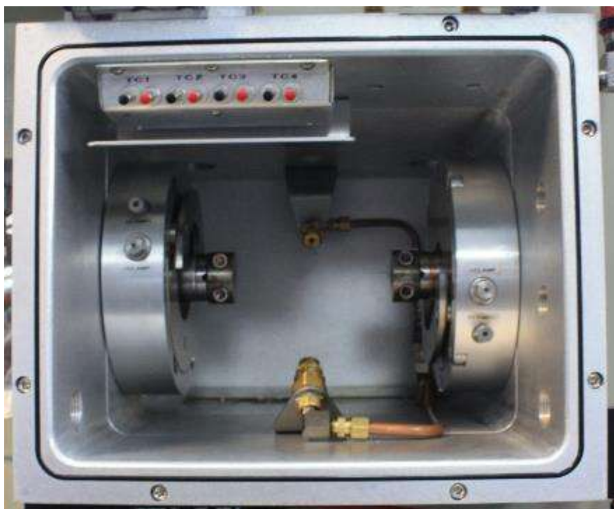
Рисунок 2.10 – Рабочая камера модуля Torsion
