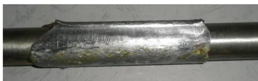
Рисунок 46 – Фотография раската после первого прохода в СК ОВР
