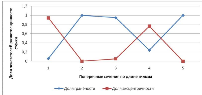
Рисунок 18 – Распределение  $A_{\Delta}$  и  $A_{ГР}$  по длине гильзы наружным диаметром  $\varnothing 222 \times 19,82$  мм, марка стали 32Г2А
