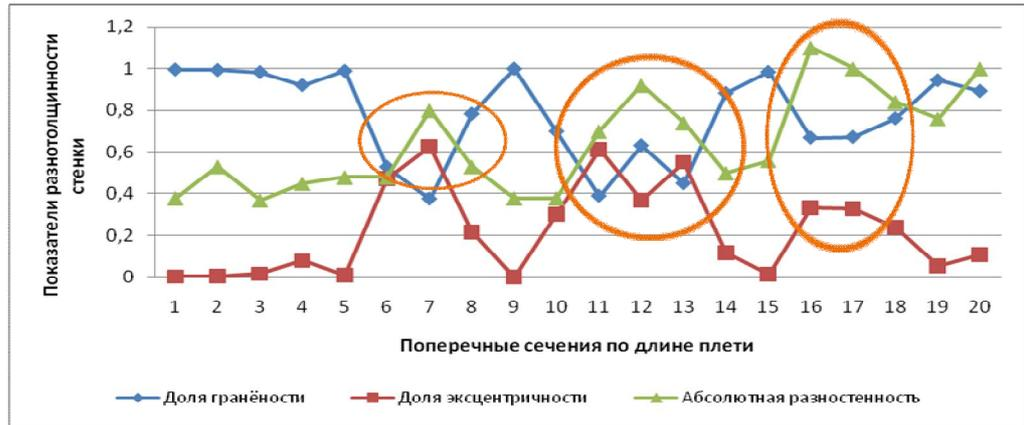
Рисунок 23 – Распределение  $\Delta S$ ,  $A_{\Sigma}$  и  $A_{ГР}$  по длине готовой трубы  $\varnothing 219 \times 6,0$  мм, полученной с использованием СК стана PQF 241 мм (сталь 20, приведено две трубы для одной плети)
