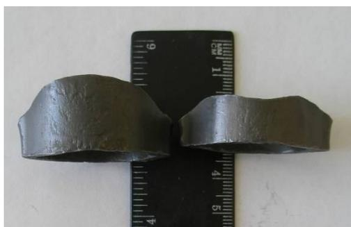
Рисунок 47 - Характер истечения металла после первого прохода (ПК, вид сверху на обжимную зону калибра) с использованием калибров: ОВР (вид слева) и NRD
