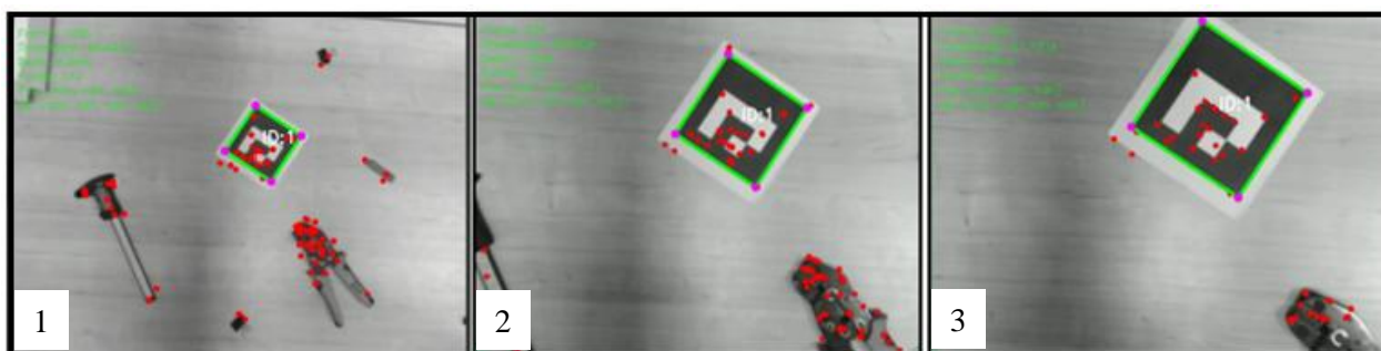
Рисунок 57 – Кадры с видеокамеры макета ВИНС во время снижения с коррекцией по опорному маркеру и опорным точкам, отслеживаемым KLT-трекером
