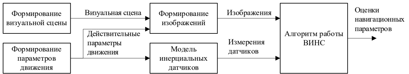
Рисунок 26 – Схема информационных связей в программе моделирования работы ВИНС
