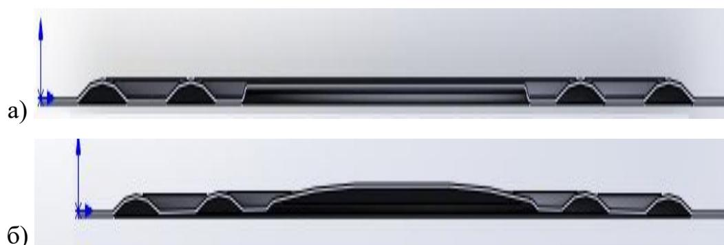
Рис. 2.3.3. Нормальная (а) и деформированная (б) разделительная мембрана.
