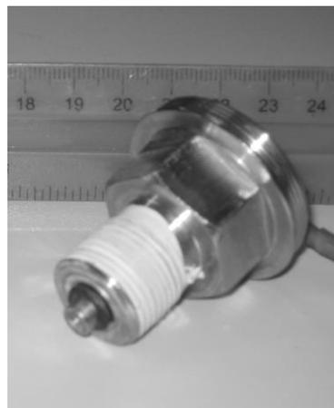
Рис. 4.1.6. Общий вид преобразователя давления типа Б (1 – узкий канал, 2,3 – чувствительные мембраны, 4 – выходы тензометрического моста)
