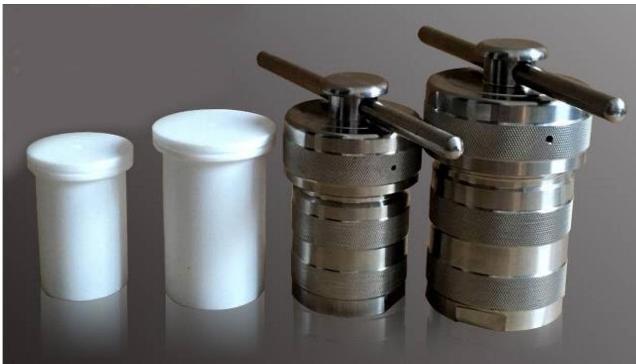
Рисунок 1.2 – Автоклавы, используемые в сольвотермальном синтезе
