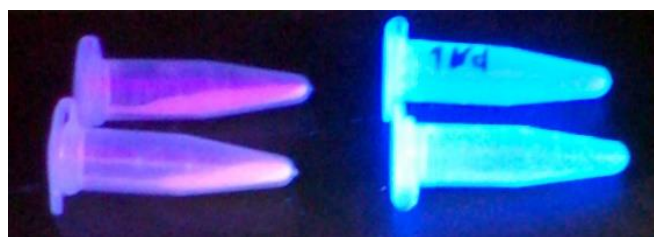
Рисунок 3.19 – Визуальное наблюдение люминесценции под ультрафиолетовой лампой в образцах, допированных европием (а) и неодимом (б)
