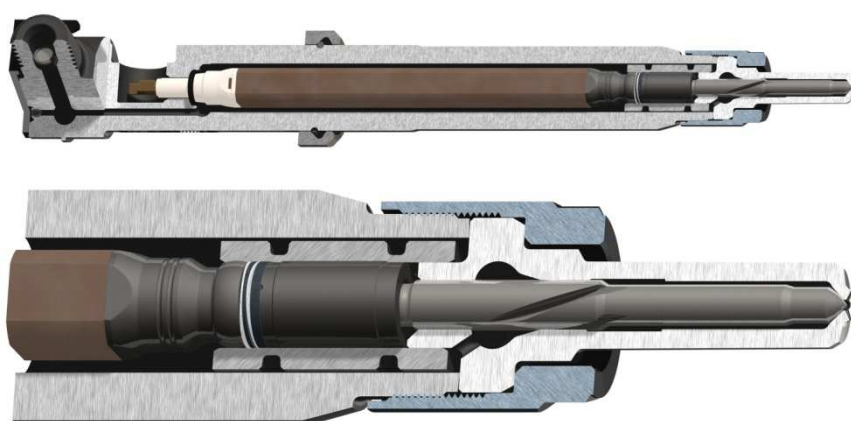
Рис. 2.10 Форсунка Delphi с прямым пьезоприводом иглы
