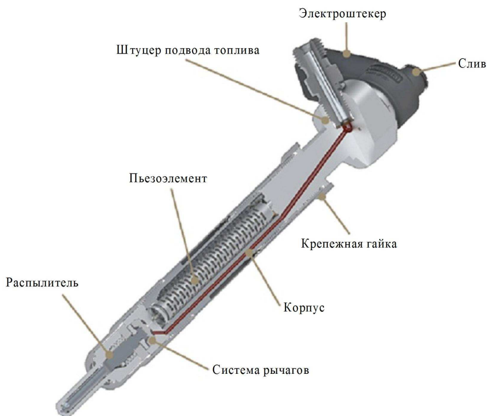
Рис. 2.12 Форсунка Continental с прямым пьезоприводом иглы [148]
