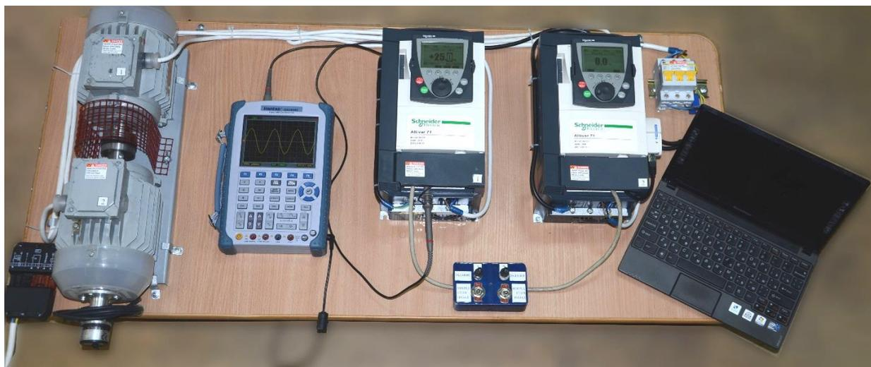
Рис. 1.22. Стенд для проведения экспериментальных исследований (1- электромашинный агрегат; 2, 3- преобразователи частоты; 4- генератор сигналов; 5- *USB*-осциллограф; 6- персональный компьютер)
