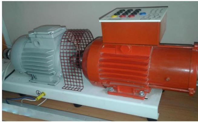
Рис. 1.26 Электромашинный агрегат с асинхронным двигателем с фазным ротором
