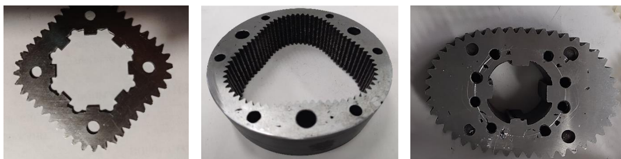
Рисунок 1.35 - НЗК, составленные из дисков, вырезанных на лазере [47, 49]
