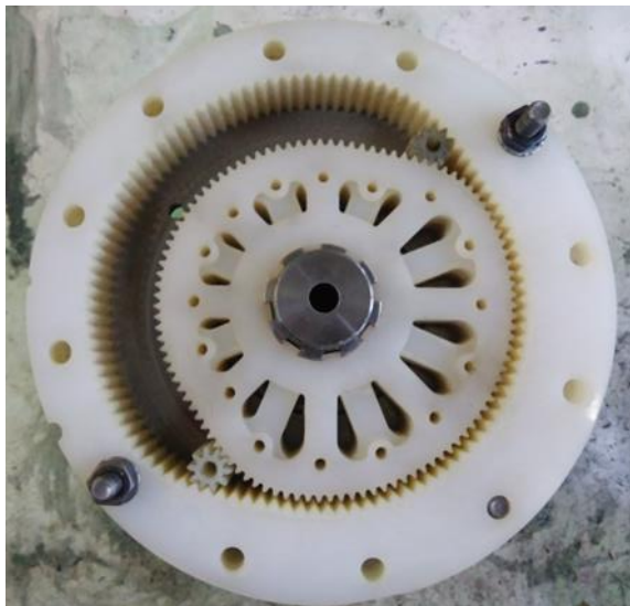
Рисунок 4.7 - ПРМ 2-2: а - без выстоек [46], б - с выстоями [51]
