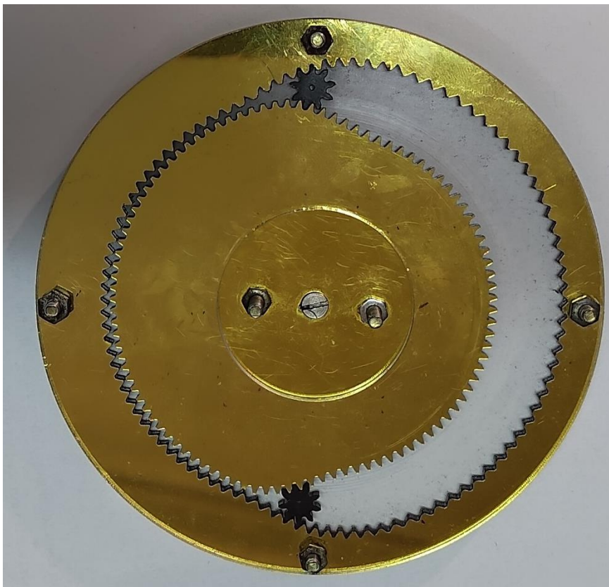
Рисунок 4.10 - ПРМ 1-1 с выстоями и модификацией эпицикла
