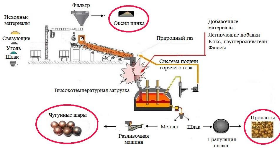
Рисунок 5.1 - Технологическая схема утилизации медеплавильного шлака.
