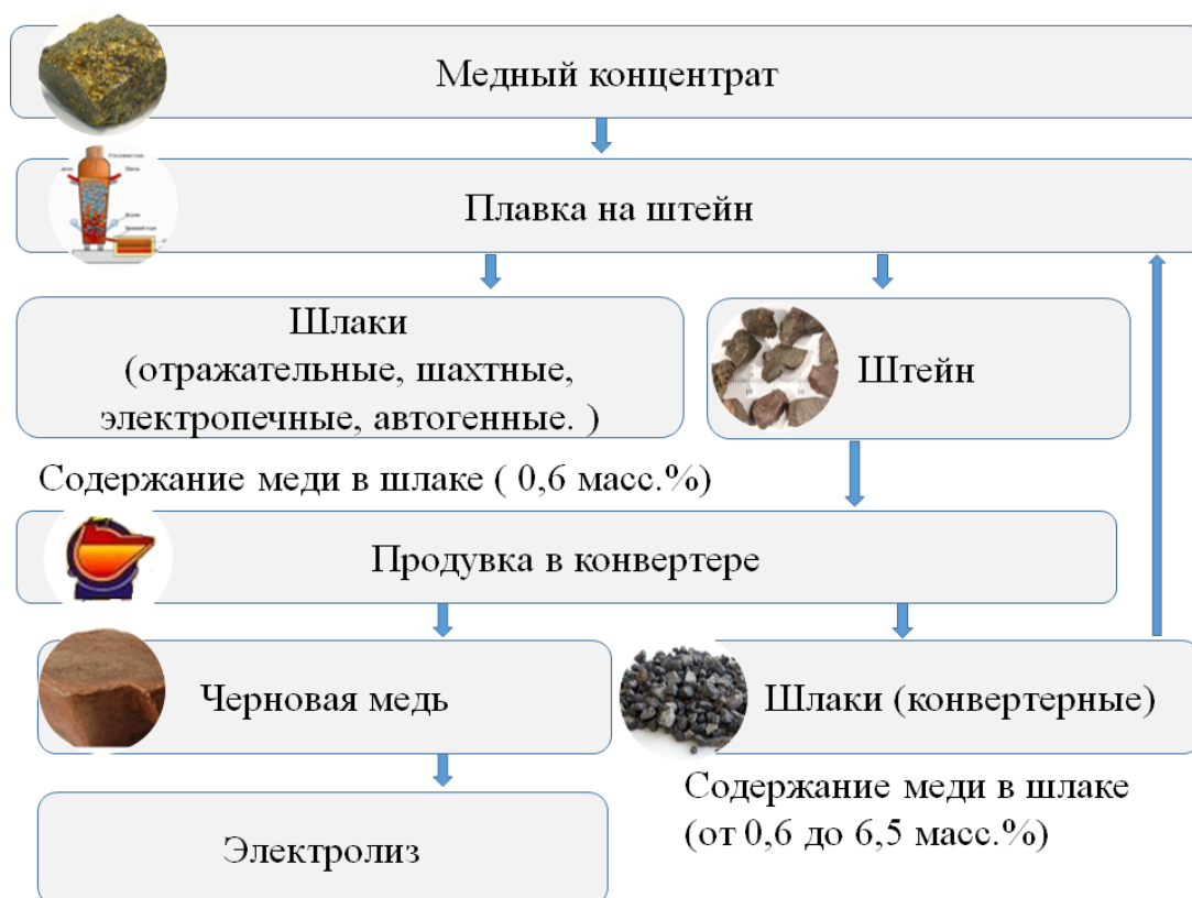
Рисунок 1.2 - Технологическая схема производства меди с образованием шлака.
