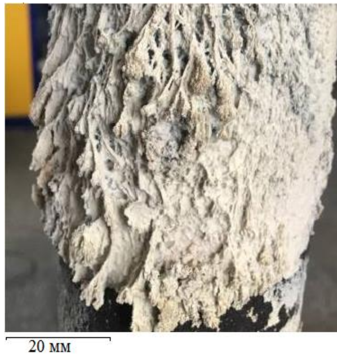
Рисунок 2.10 - Фотография конденсата оксида цинка, осаждённого на электроде.
