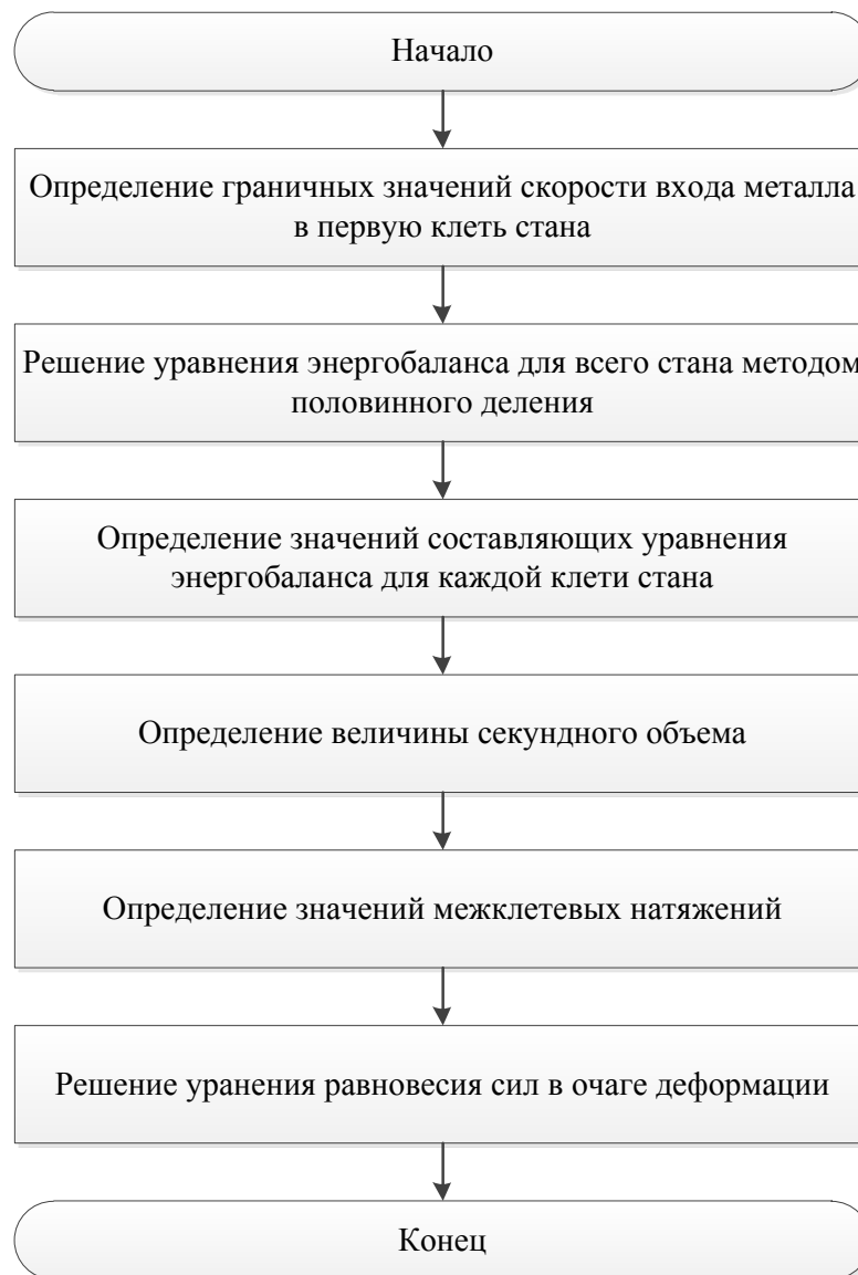
Рисунок 21 – Блок-схема реализации математической модели
