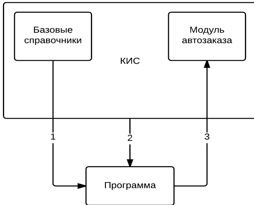
Рис. 4.5. Схема интеграции программы формирования планogramм выкладки товаров с КИС
