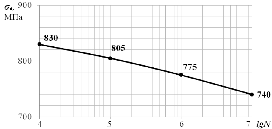
Рисунок 5.9 – Кривая усталости для наноструктурного титанового сплава Ti-6Al-4V
