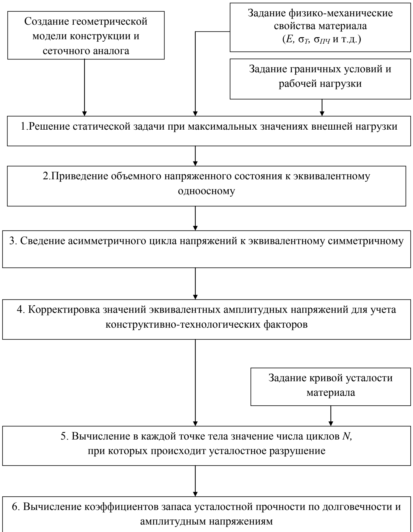
Рисунок 5.1 – Схема алгоритма расчета многоциклового усталостной прочности конструкций
