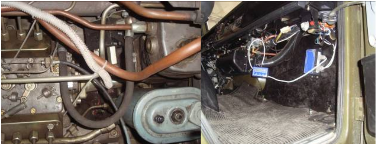
Рисунок 3.5 – Принципиальная схема расходомера топлива «Порт-1» и его установка на испытуемый образец АМН (КАМАЗ-5350).
