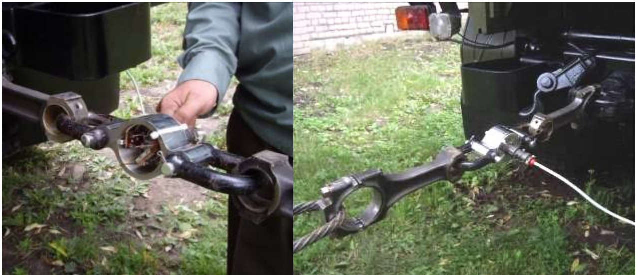
Рисунок 3.4 – Установка тягового тензометрического звена на АМН.
