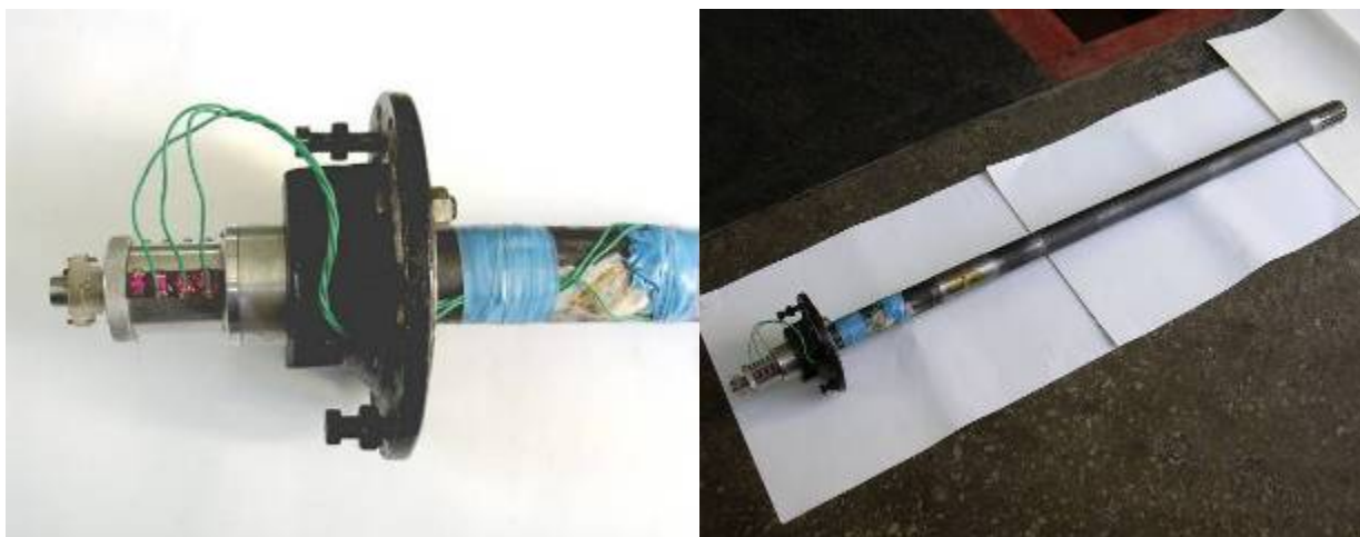
Рисунок 3.6 – Установка тензометрических датчиков на полуось АМН.
