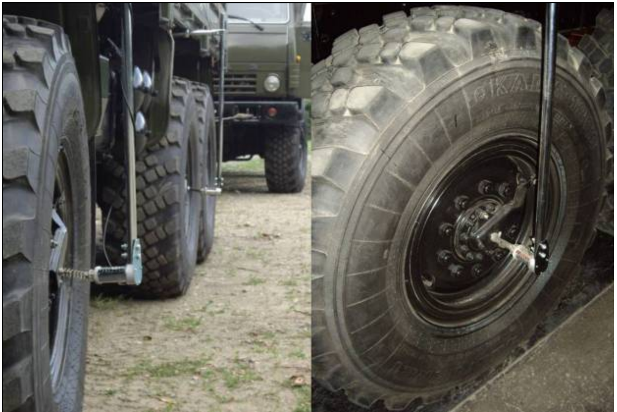
Рисунок 3.3 – Установка торцевых токосъемников на АМН.
