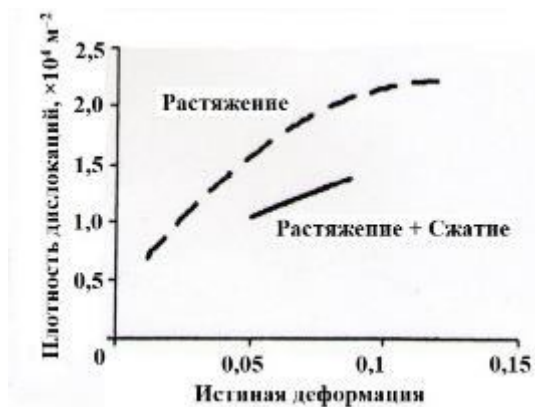
Рисунок 1.11 – Изменение плотности дислокаций во время растяжения и последующего сжатия стали 0,16% С+1,43% Мn+0,41% Si [70]
