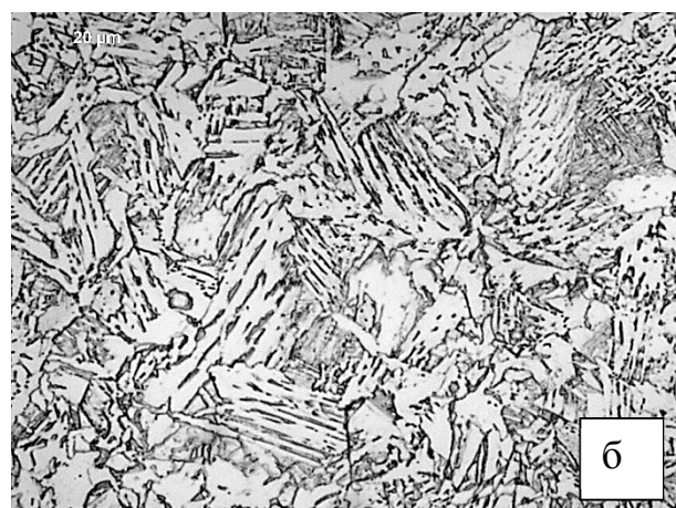
Рисунок 4.4 – Микроструктура стали 06Г2ФБ с ферритно-перлитной (а) и ферритно-бейнитной (б) структурами (аустенитизация 1000 °С) после знакопеременной деформации сжатие+растяжение на 3 %
