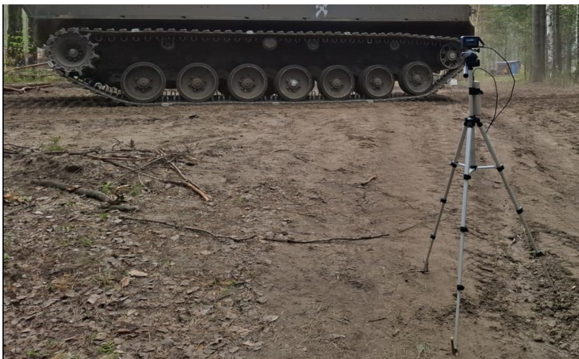
Рис. 3.10. Объект исследования, расположение маркеров на среднем опорном катке, ведущем и направляющем колесах, звеньях гусеницы и установка камеры-регистратора
