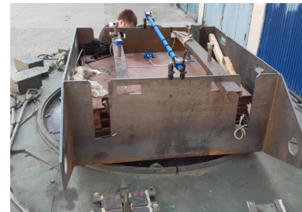
Рис. 3.22. Установка высокочастотного датчика ускорения, низкочастотного датчика ускорений и угловых скоростей, спутниковых антенн на весовом макете
