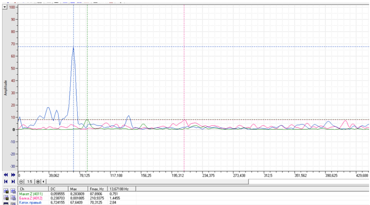
Рис. 2.18. Спектр процесса динамического вибрационного нагружения в контролируемых точках измерений («каток», «балка», «весовой макет») при движении по бетонной трассе со скоростью V=38,0 км/ч
