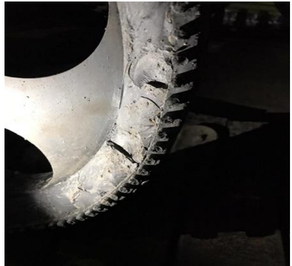
Рис. 1.3. Разрушенные серийный каток (а) и опытный каток (б) из композитного материала
