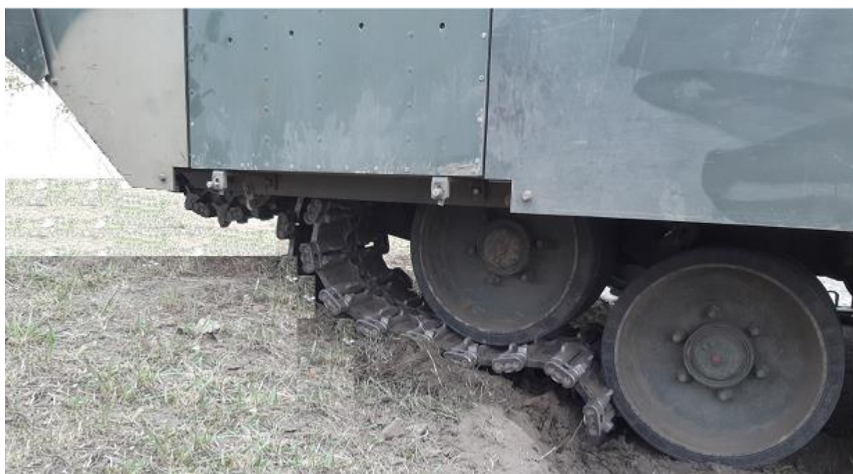
Рис. 1.2. Пример захвата гусеницы ведущим колесом
