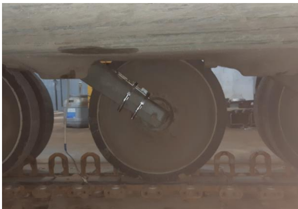
Рис. 3.20. Установка датчика ускорения на балансир опорного катка (точка измерения «каток»)
