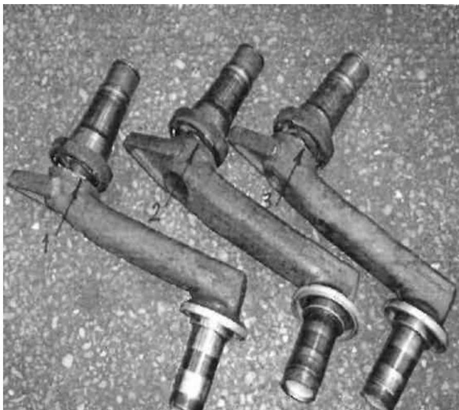
Рис. 1.1. Пример усталостного разрушения балансиров БГМ в следствие высокочастотного нагружения при движении по твердому грунту (бетонной трассе)
