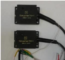
Two black rectangular electronic modules with wires.                             | Усиление, преобразование и бесконтактная передача на приемник сигнала с тензорезисторов |
