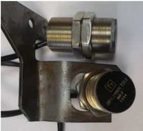
A metal receiver unit with a cylindrical component and a black circular sensor. | Прием сигнала с передатчика и передача на регистратор АЦП L-Card E 14-440               |
