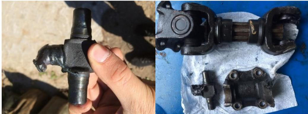
Рисунок 1.18 – Разрушение карданной передачи, расположенной между угловым редуктором и водометом
