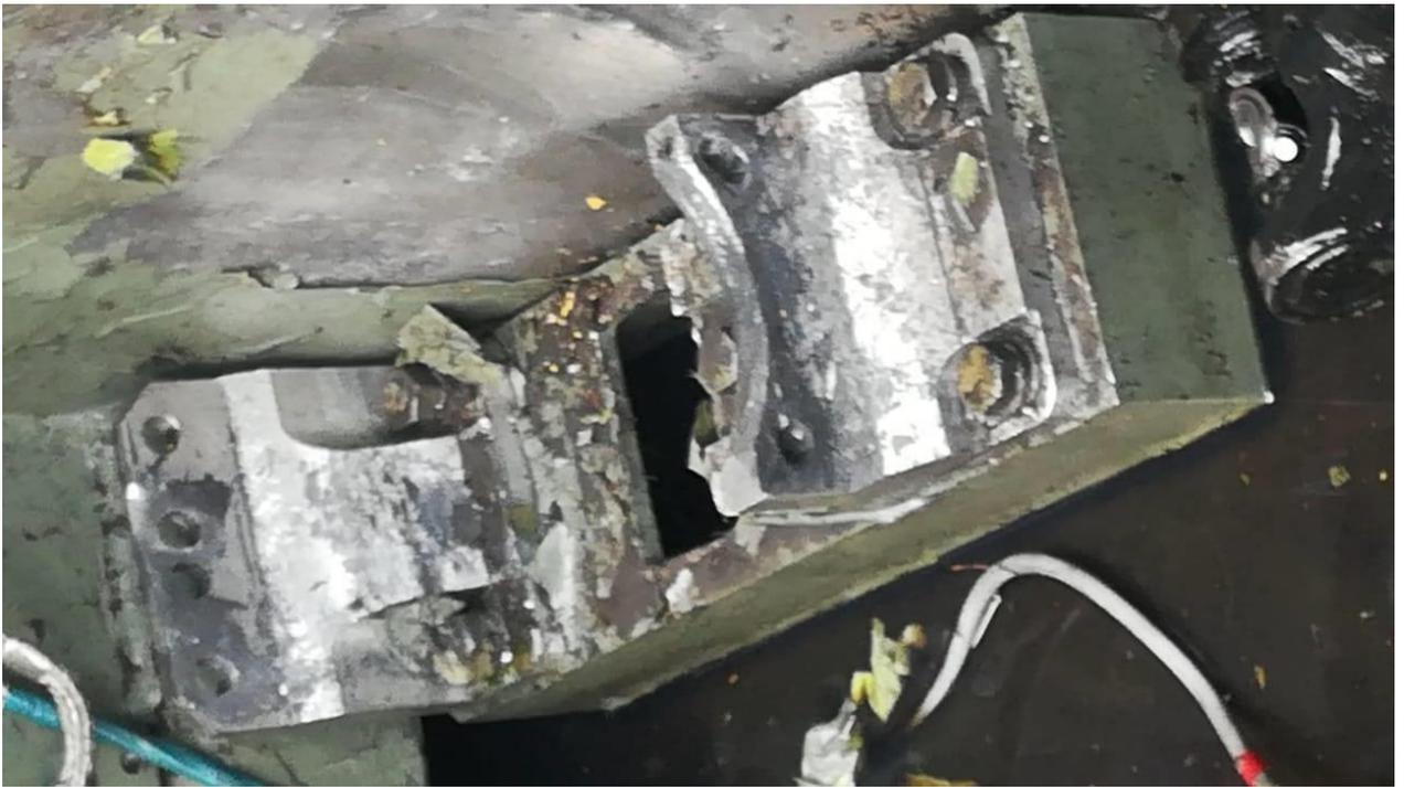
Рисунок 1.23 – Общий вид деформированных креплений углового редуктора
