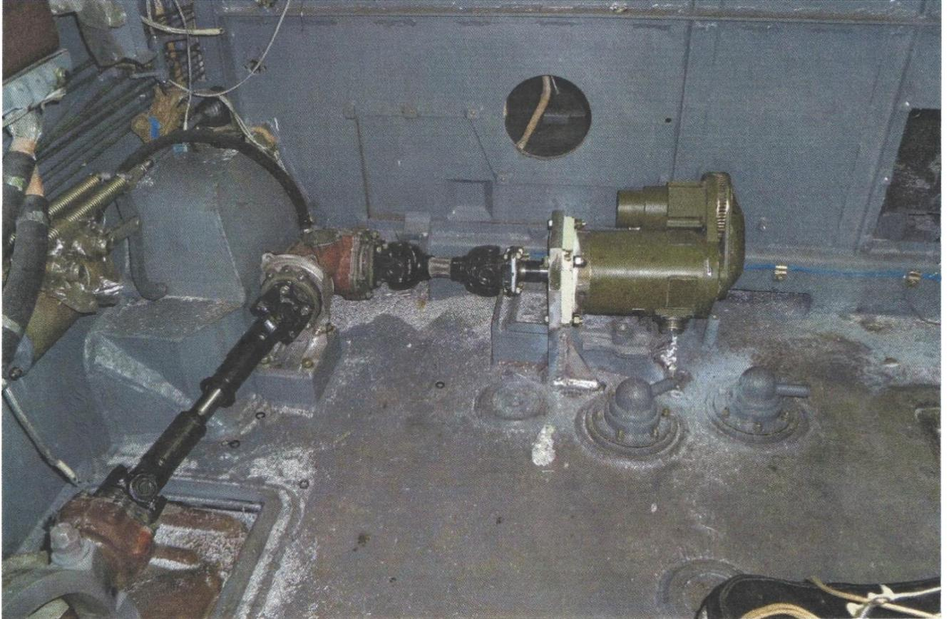
Рисунок 3.2 – Общий вид стенда испытаний привода водомета
