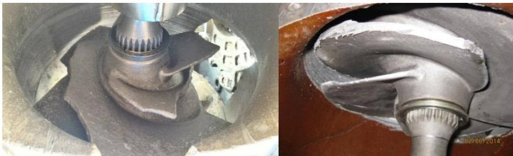
Рисунок 1.20 – Разрушение рабочих колес водомета
