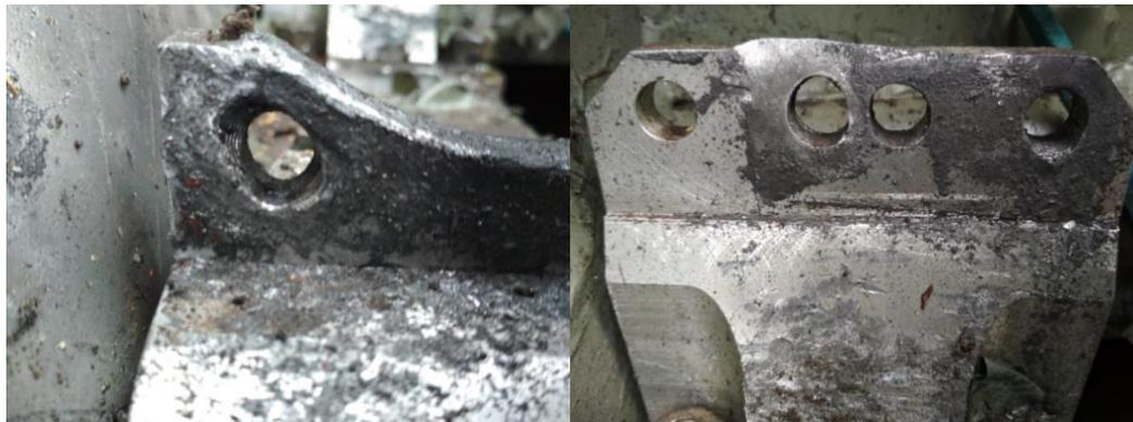
Рисунок 1.19 – Деформация креплений углового редуктора
