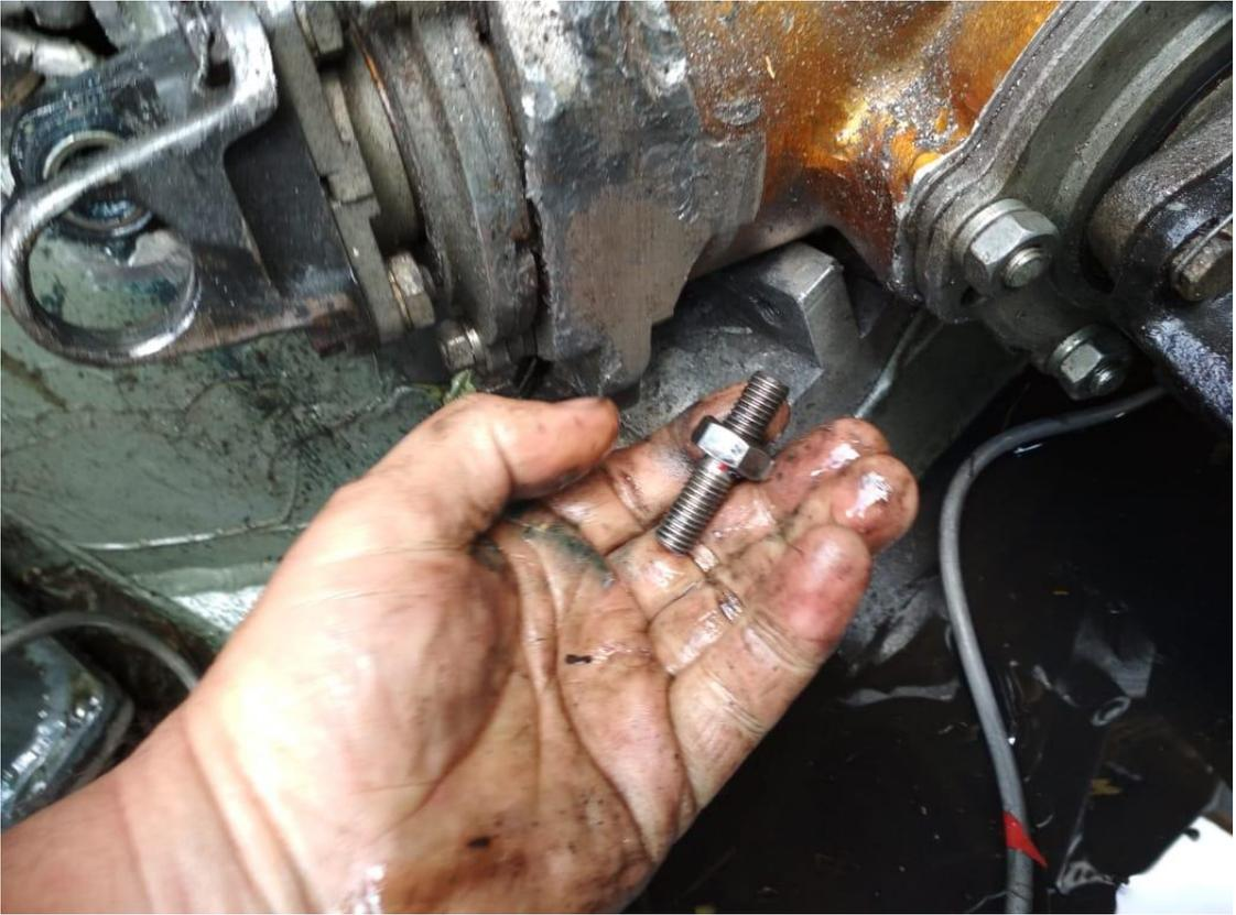
Рисунок 1.21 – Разрушения болта крепления углового редуктора (с лево) и разрушение карданной передачи с право
