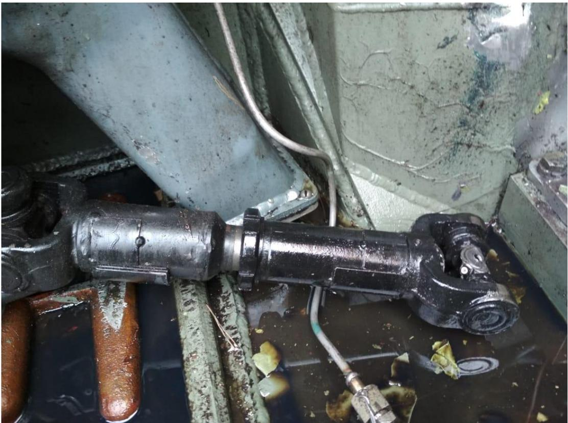
Рисунок 1.22 – Разрушение карданной передачи между механизмом передач и поворотов и угловым редуктором
