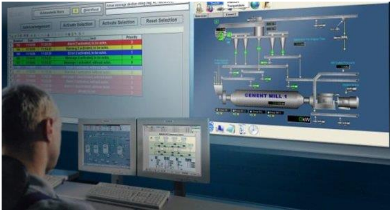
Рисунок 4.12. SCADA система управления мельницей цементного производства
