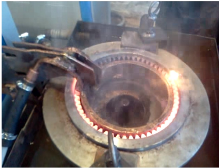
Рис. 60: Термообработка внутреннего отверстия цилиндрических шестеренок индукционным способом нагрева токами промышленной частоты.
