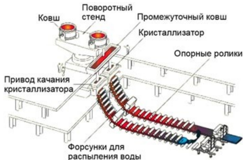
Рис. 40: Общая схема машины непрерывного литья заготовок.
