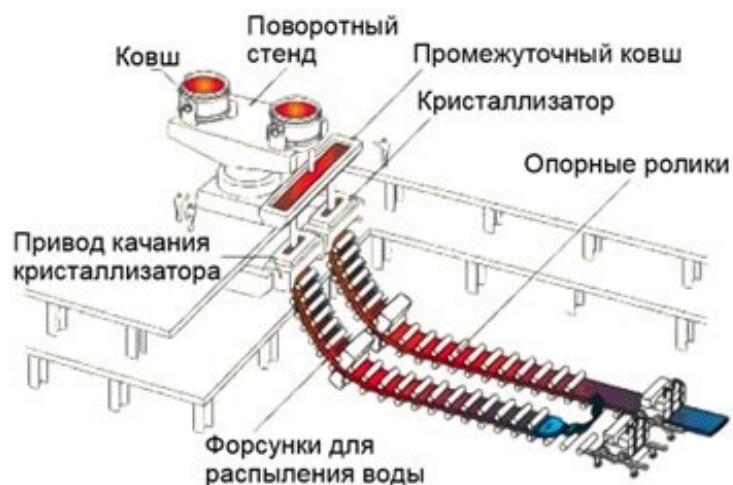
Рис. 2: Общая схема непрерывной разливки стали и горячей прокатки
