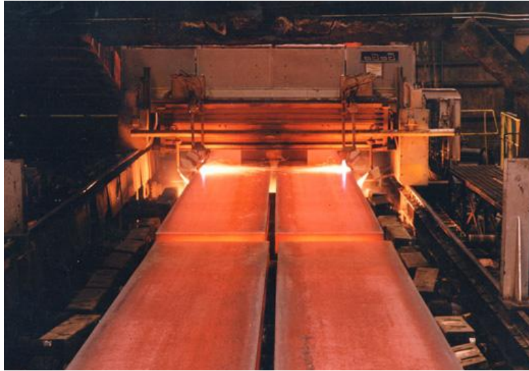
Рис. 12: Изготовление листового проката из сляба.
