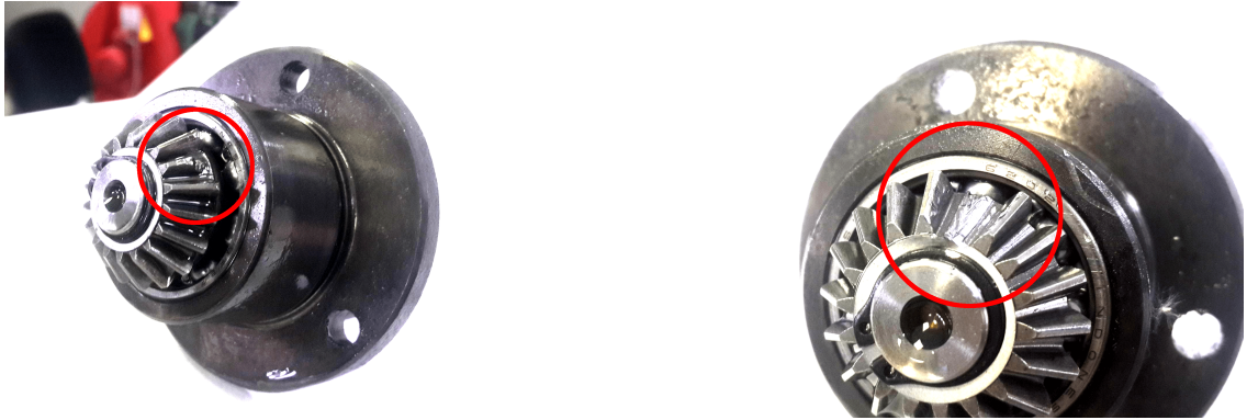
Рис. 74. Шестерня со сколотым зубом Рис. 75. Шестерня со сломанным зубом
