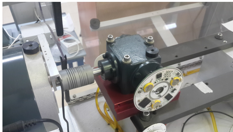
Рис. 73. Зубчатый редуктор с датчиком ускорений
