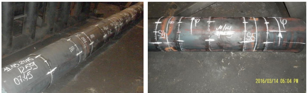
Рисунок 42 – Недокат, образовавшийся во всех клетях стана FQM а – общий вид; б – очаг деформации чистовых клетей №№ 4, 5 (S4 и S5)
