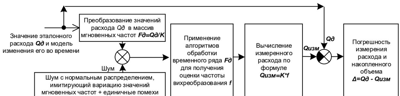
Рисунок 3.9 – Имитационная модель вихревого расходомера
