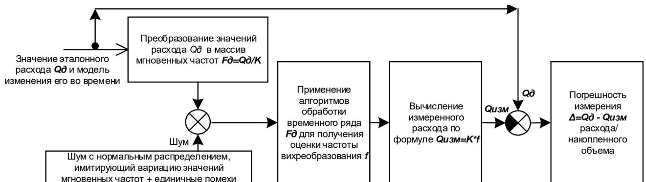
Рисунок 4.10 – Имитационная модель обработки информации о частоте вихреобразования в вихревом расходомере
