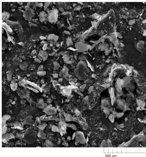
Рисунок 3.15. SEM фотография пробы после опыта с исходным соотношением  $C/SiO_2=2/1$  после синтеза.
