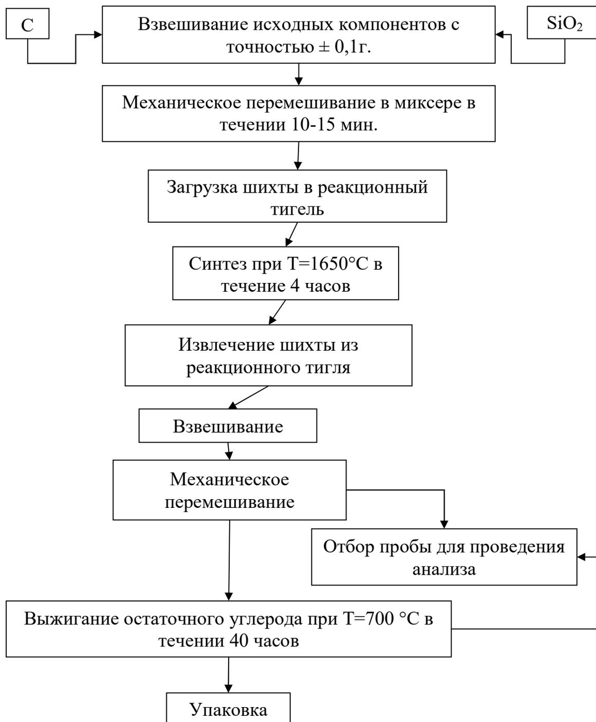
Рисунок 3.35. Предлагаемая технологическая схема синтеза SiC.
