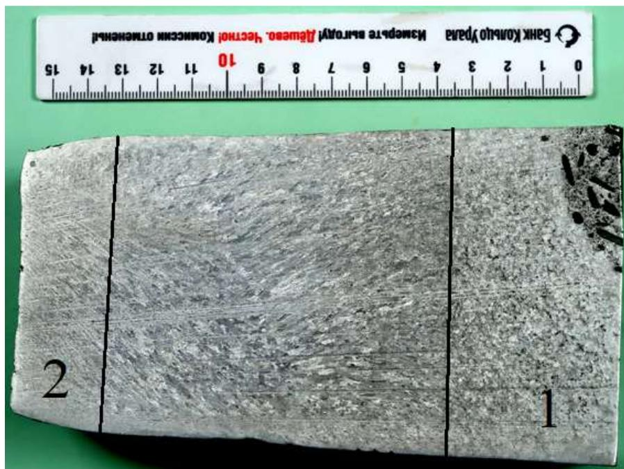
Рисунок 5.14. Структура полученного слитка в разрезе.
