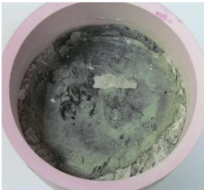
Рисунок 3.22. Зелёный карбид кремния на поверхности шихты в корундовом тигле.
