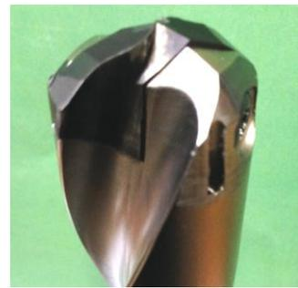
Рисунок 20 – Сборное сверло со сменной режущей головкой повышенной прочности (Заявка на пат. № 2014132270 от 05.08.2014)
