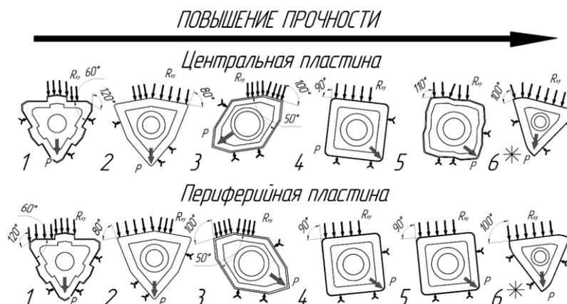
Рисунок 9 – Ранжирование форм СРП сборных сверл разных фирм по повышению прочности (\* разработанная форма СРП)
