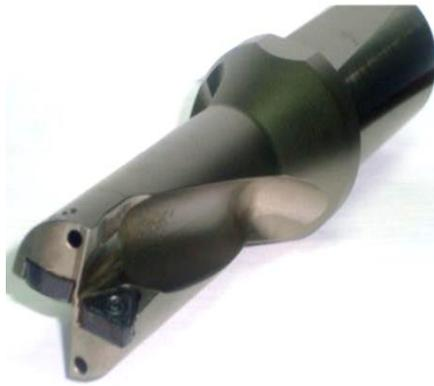
Рисунок 19 – Сборное сверло с СРП повышенной прочности (Пат. №2539255)
