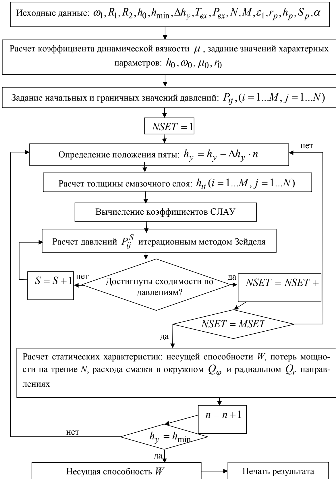
Рисунок 2.9. Алгоритм расчета несущей способности и гидромеханических характеристик упорного ПС: NSET – номер самой грубой сетки, MSET– номер самой мелкой сетки
