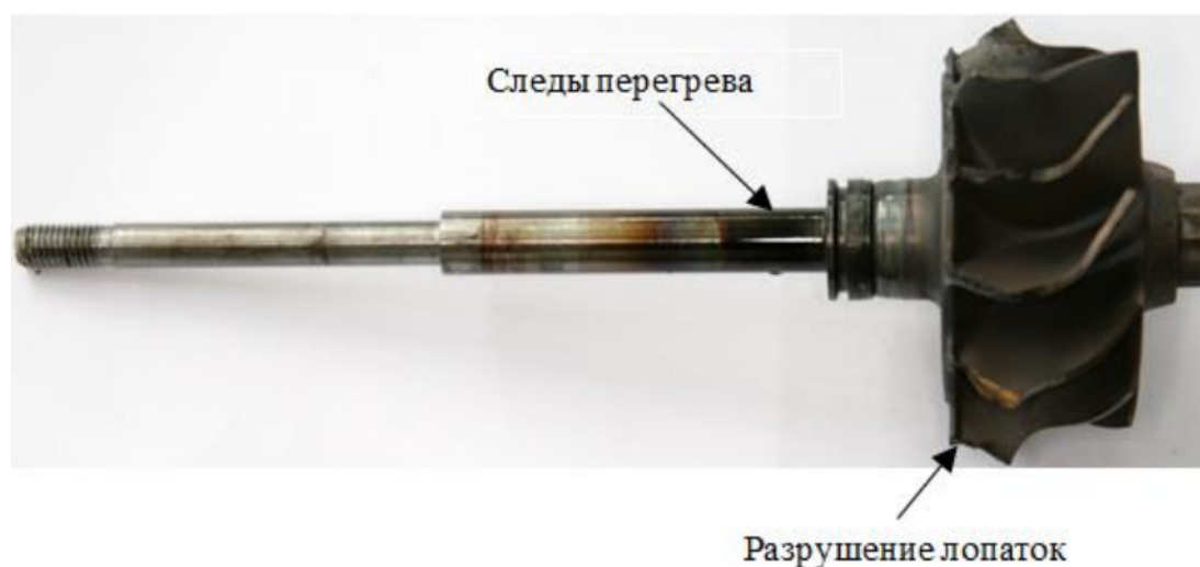
Рисунок 1.8. Повреждение вала ротора вследствие превышения допустимой частоты вращения
