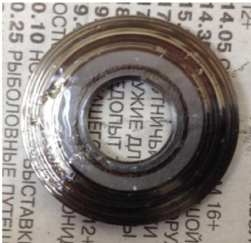
Рисунок 1.4. Износ несущей поверхности упорного ПС (а) – пяты; б) подпятник)
